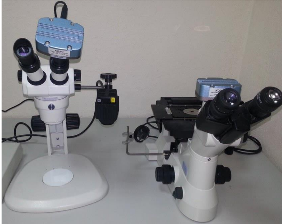
Şekil 4. 9. Mikro hasarın incelenmesinde kullanılan KOZO marka USB mikroskop kameralar
