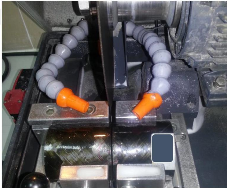
Şekil 4. 7. Numunelerin kesme işleminde kullanılan METKON marka kesme cihazı
