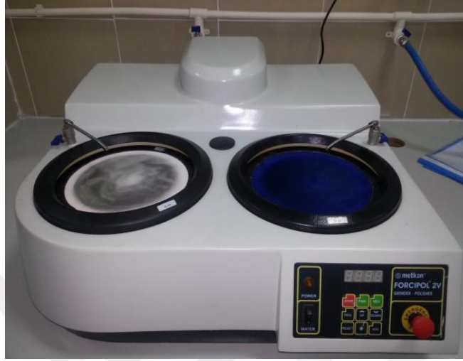
Şekil 4. 8. Mikro yapının hazırlanmasında ve incelenmesinde kullanılan METKON marka zımparalanma ve parlatma cihazı
