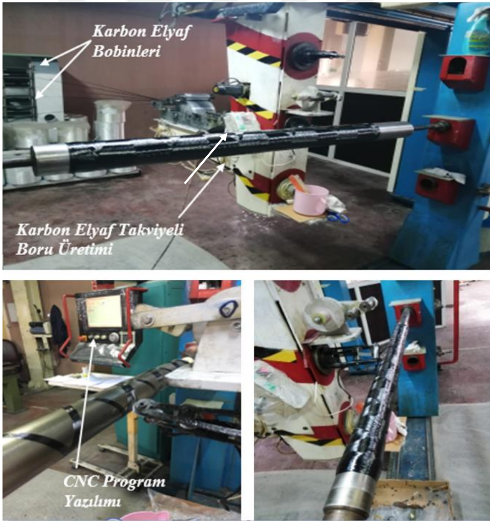
Şekil 4. 1. Filaman sarım karbon/epoksi boruların üretimi
