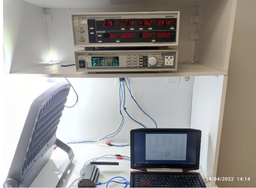
a) LT-101A LED sürücü test cihazının ölçtüğü elektriksel değerler
