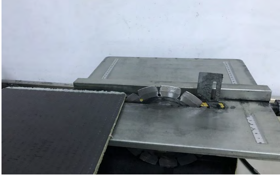
Şekil 3.29. Sulu kesim makinesi ve kompozit malzemenin kesim aşaması
