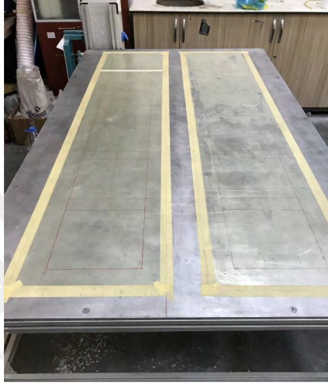
Şekil 3.16. Kompozit üretiminde kullanılan vakum infüzyon tezgâhı
