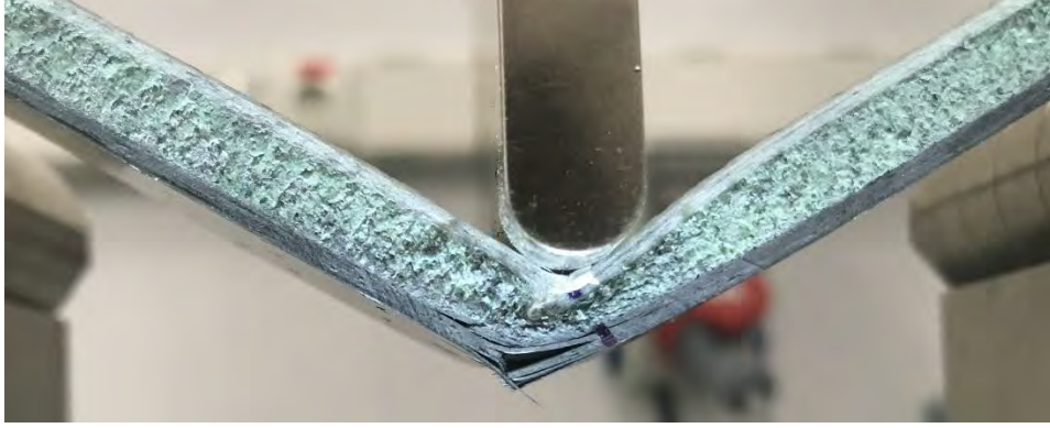
Şekil 4.20. SB3 numunesinin hasar alması
