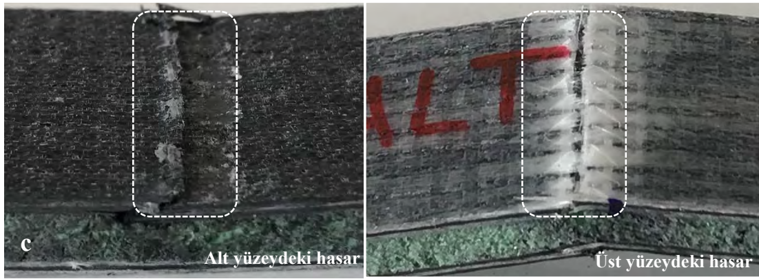
Şekil 4.31. Üç nokta eğilme altındaki SB8 numunesinde oluşan hasar mekanizmaları
