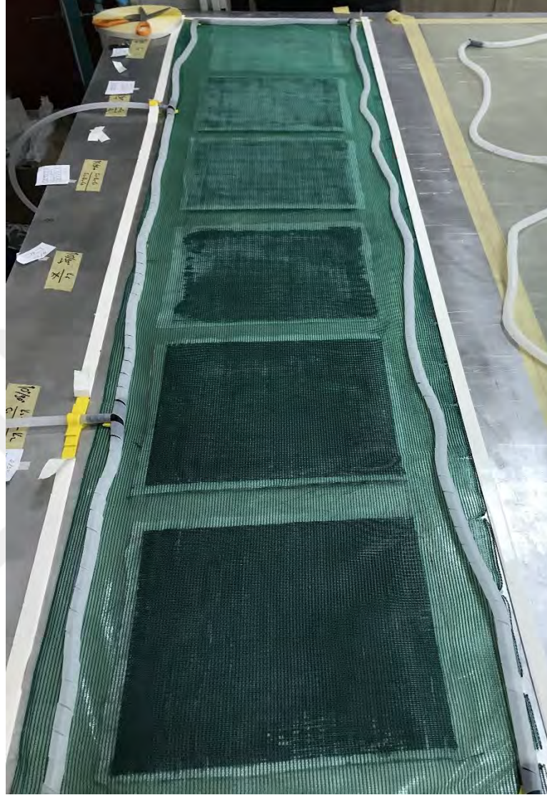
Şekil 3.23. Vakum infüzyon filesi üzerine reçine ve hava akış hattının oluşturulması
