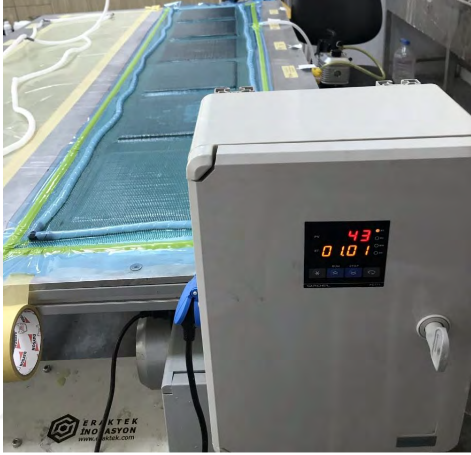
Şekil 3.26. Tezgah ısıtma işleminin gerçekleştirilmesi
