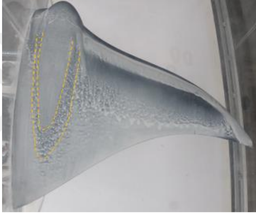
Şekil 39. Bombeli bölge türbülans akış yapısı
