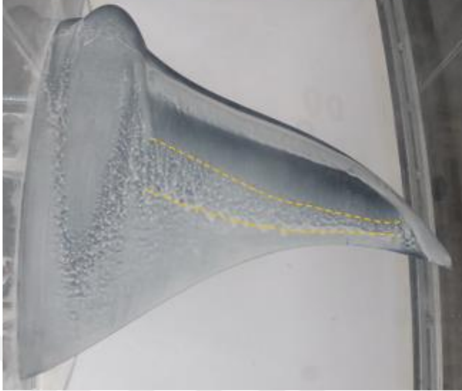
Şekil 36. Geçiş ve akışın tekrar yüzeye bağlandığı bölge
