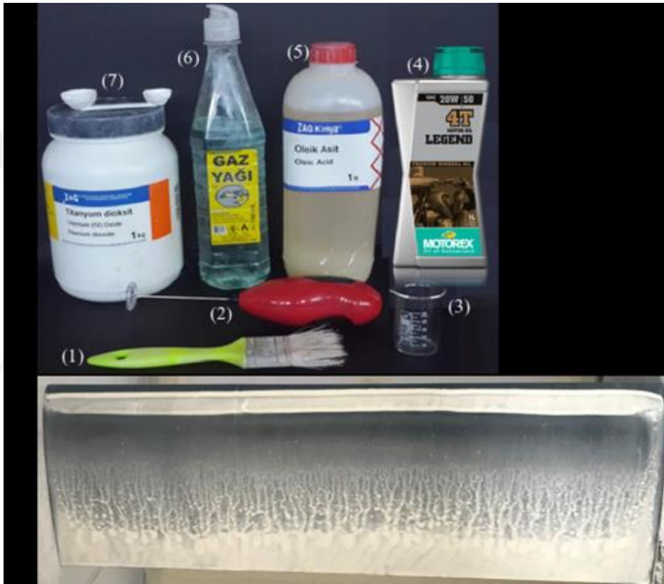
Şekil 15. Yüzey yağ akış görüntülemesinde kullanılan malzemeler ve yüzey yağ akış görüntülemesi örneği (Seyhan, 2022)
