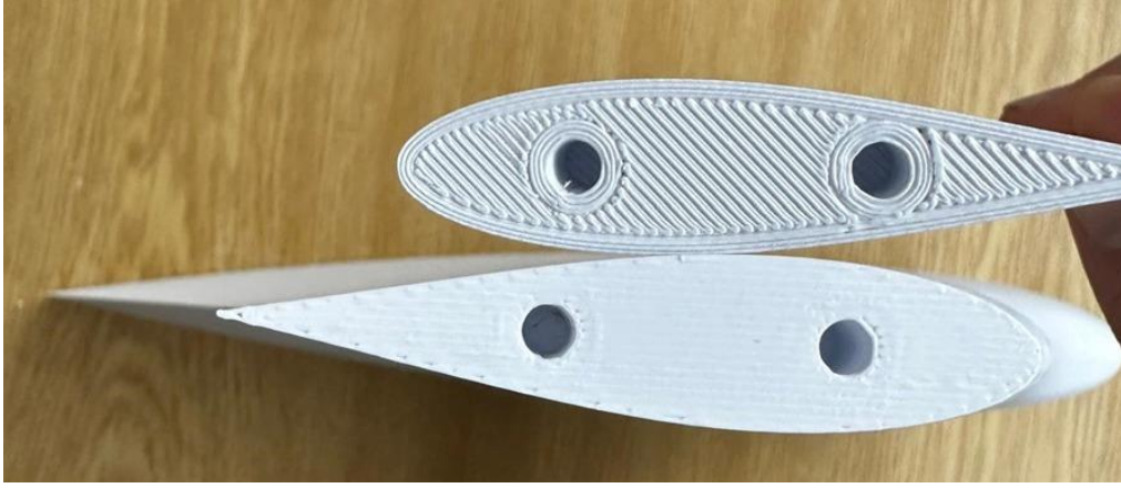
Şekil 8. İki parça olarak üretilen kanat modellerinin birleştiği bölgenin yapısının görseli.
