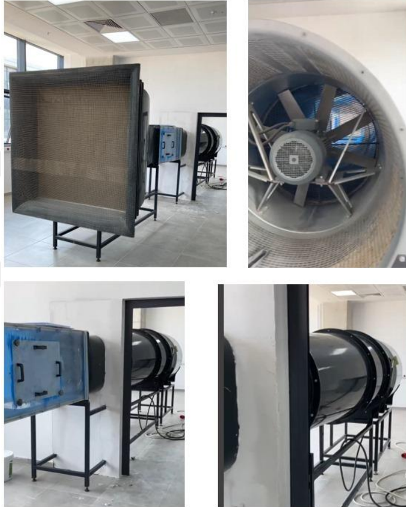
Şekil 2. Necmettin Erbakan Üniversitesi emmeli tip rüzgâr tüneli görselleri
