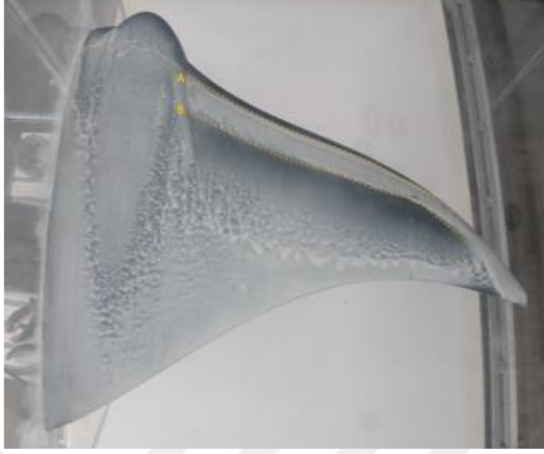
Şekil 35. Laminer kabarcık ayrılması bölgesi (A: Ayrılma Noktası – B: Birleşme Noktası)
