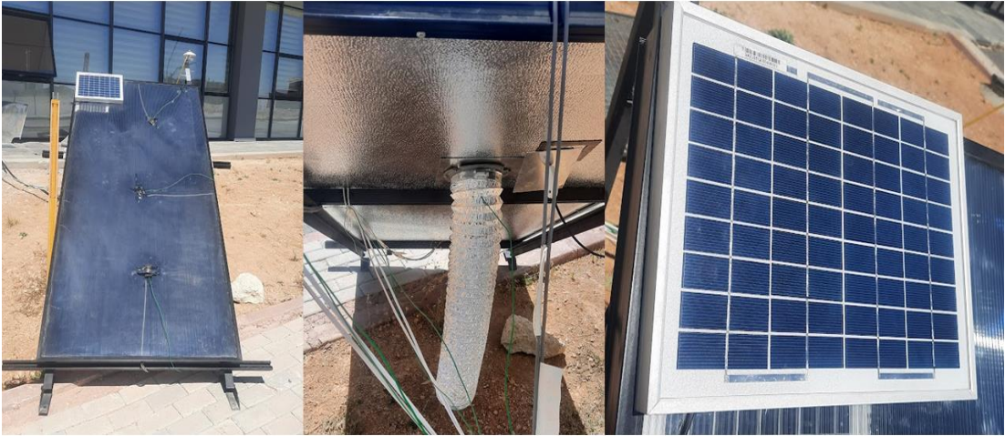
Şekil 3.6. Güneş hava kolektörünün deney düzeneği.
