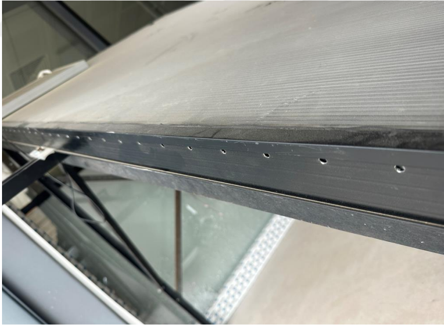
Şekil 3.4. Güneş hava kolektörünün yan hava giriş delikleri
