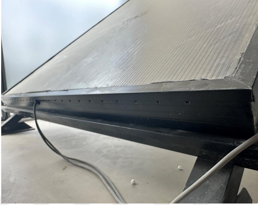
Şekil 3.3. Güneş hava kolektörünün alt hava giriş delikleri
