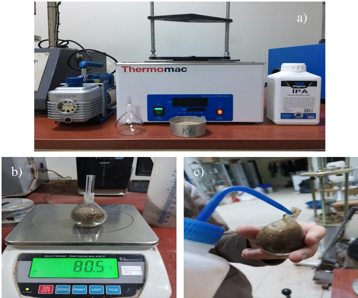
Şekil 3.10. Özgül ağırlık deneyi: a) Deney ekipmanları, b) Tartım işlemi, c) Piknometreye su eklenmesi
