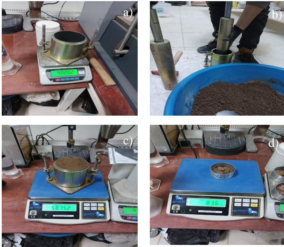
Şekil 3.12. Proctor deneyi: a) Proctor kalıbının tartılması, b) sıkıştırma işlemi, c) sıkıştırılan zeminin tartılması, d) sıkıştırılan zeminden örnek alınması ve tartılması
