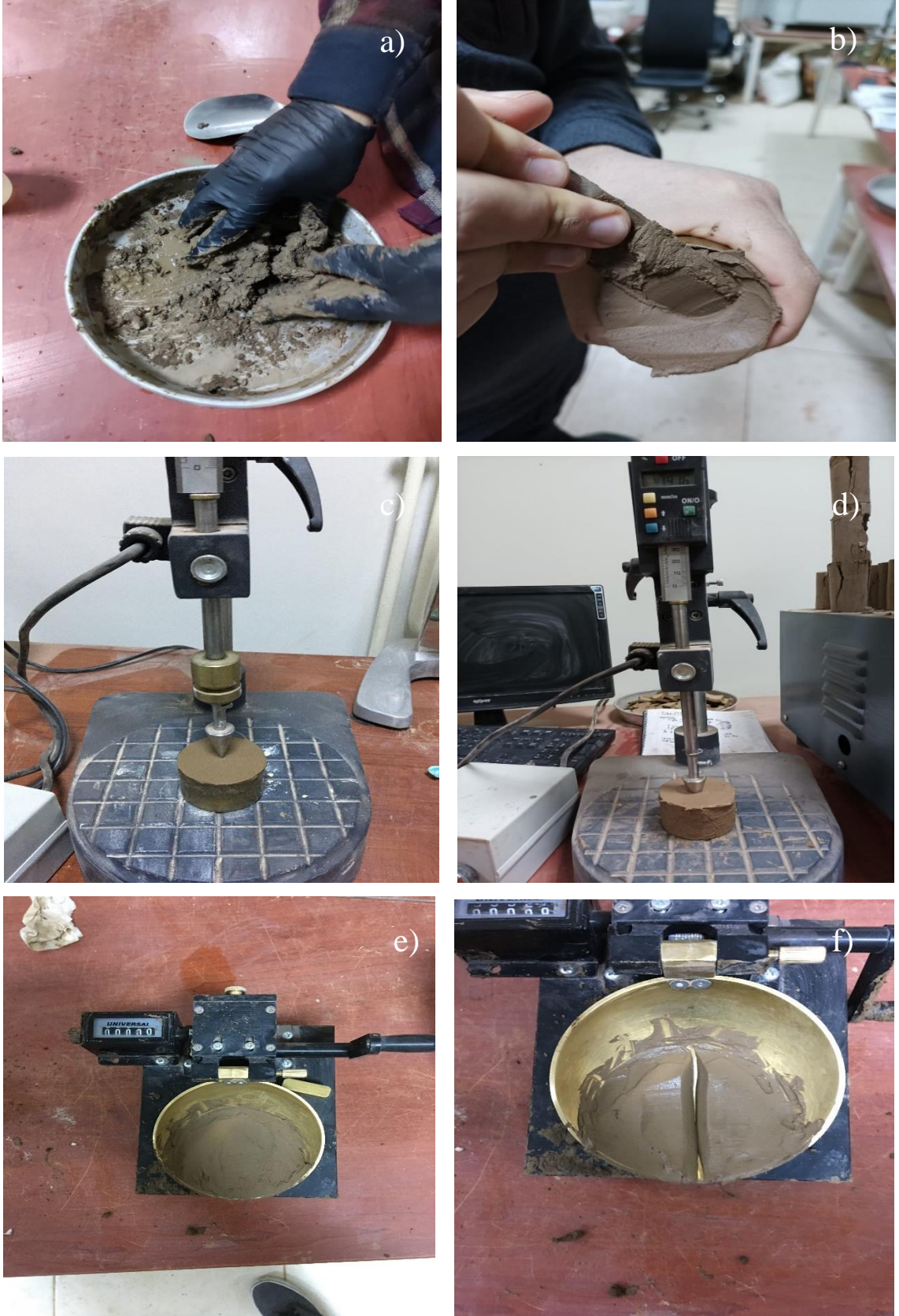
Şekil 3.6. Koni penetrasyon ve Casagrande deneyi: a) Zemin su ilave edilip yoğrulması, b) Zeminin koni penetrasyon kalıbına yerleştirilmesi, c) Koninin zemin üzerine yerleştirilmesi, d) Koni penetrasyon cihazının çalıştırılması, e-f) Casagrande deneyi
