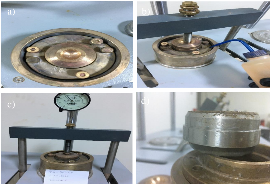
Şekil 3.14. Kompaksiyon deneyi: a) numunenin kompaksiyon aletine yerleştirilmesi, b) su ile örtülmesi, c) şişmenin ölçülmesi, d) şişme görüntüsü
