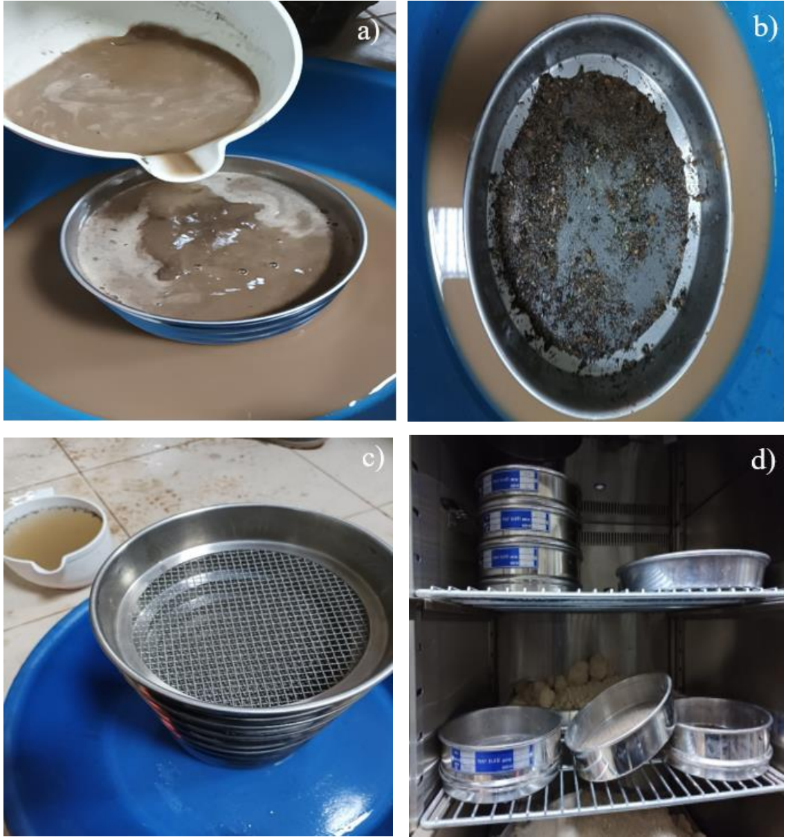
Şekil 3.5. Islak Elek Analizi: a) 0.075 mm elekten numunenin elenmesi, b) 0.075 mm elek üzerinde kalan malzeme, c) 0.075 mm elek üzerinde kalan numunenin elek takımından elenmesi, d) Elek ve numunelerin etüvde kurutulması
