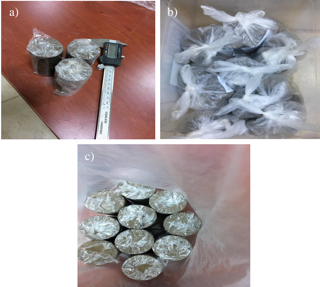
Şekil 3.17. Serbest basınç deneyi numuneleri: a) numunelerin ölçülmesi, b) numunelerin küre bırakılması, c) kür sonrası numuneler
