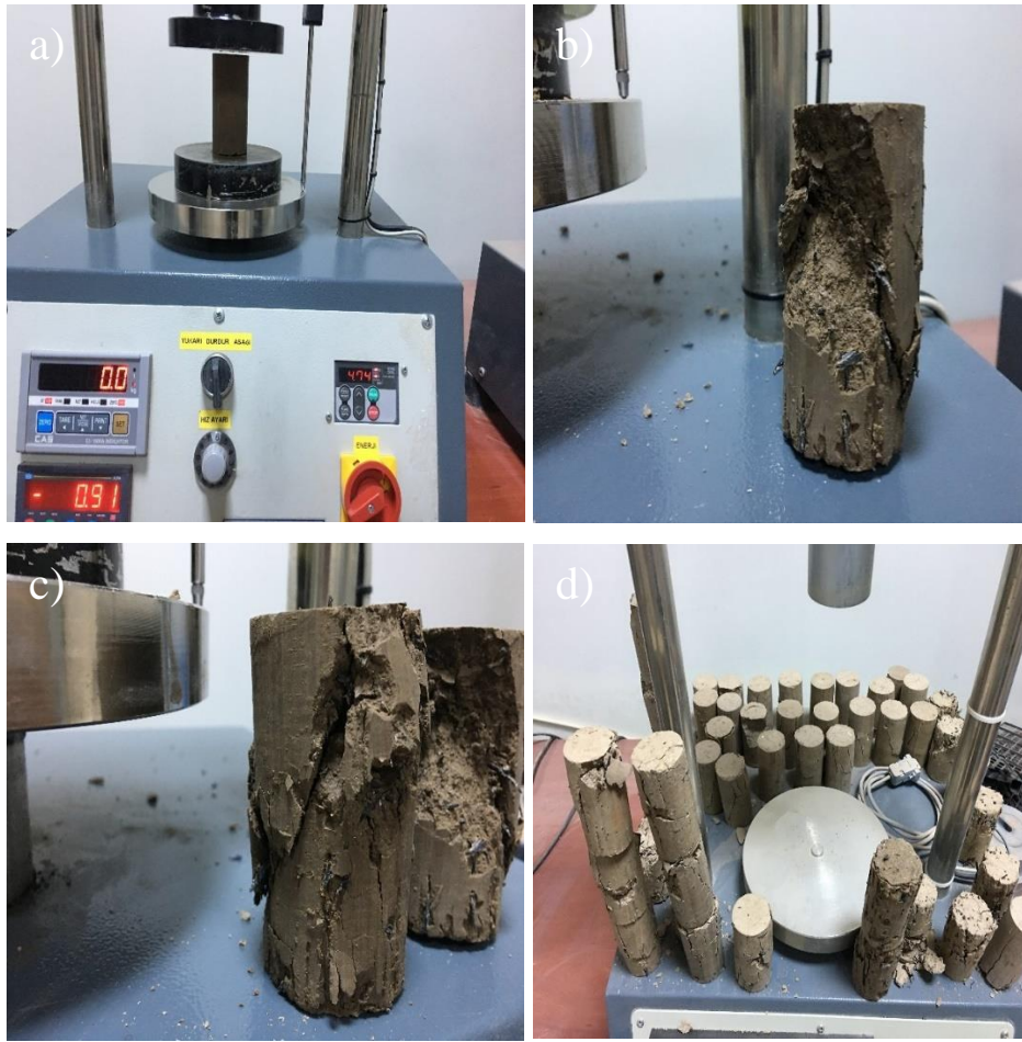
Şekil 3.18. Serbest basınç deneyi: a) numunenin cihaza yerleştirilmesi, b-c) deney sonrası numuneler, d) serbest basınç deneyine tabii tutulan karışımlar
