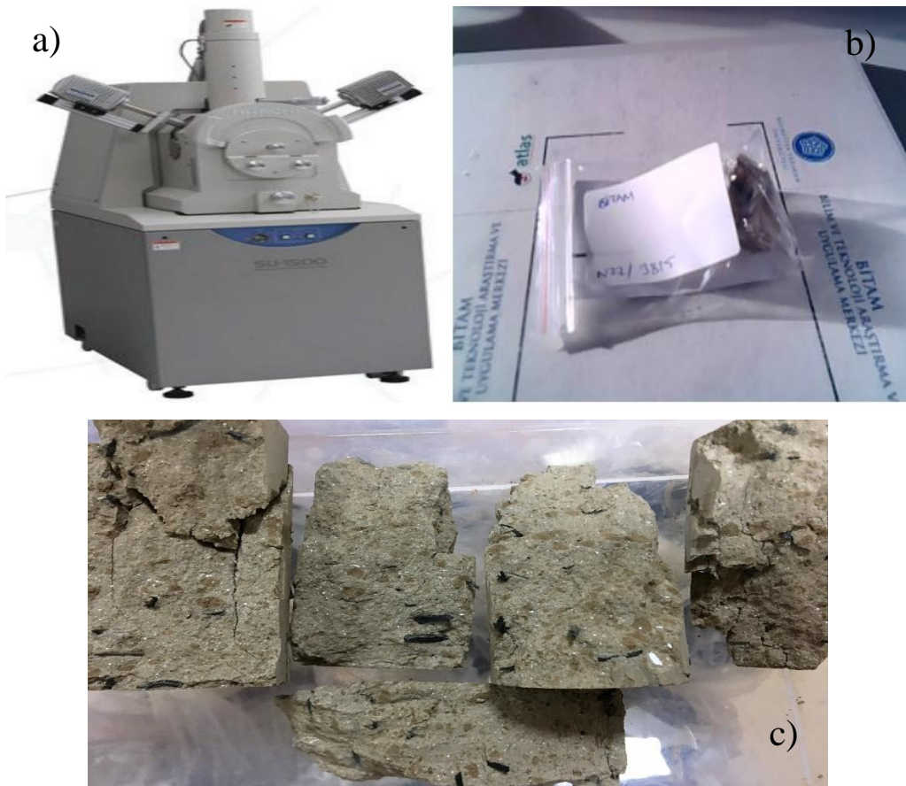
Şekil 3.22. SEM deneyi: a) deney cihazı, b) laboratuvar numunesi, c) deney öncesi numunelerin görüntüsü
