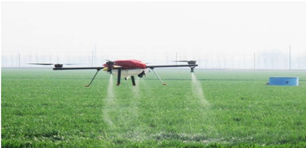
Şekil 3.3: İlaçlama Yapan İnsansız Hava Aracı (Tarım, 2018)
