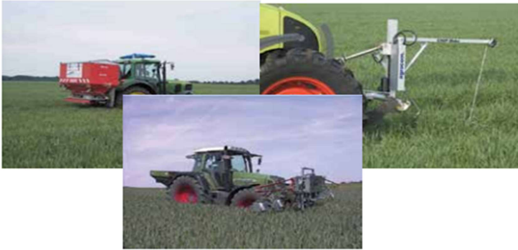
Şekil 3.8.: Sensör vasıtasıyla gübreleme faaliyetleri (Türker ve ark., 2015)
