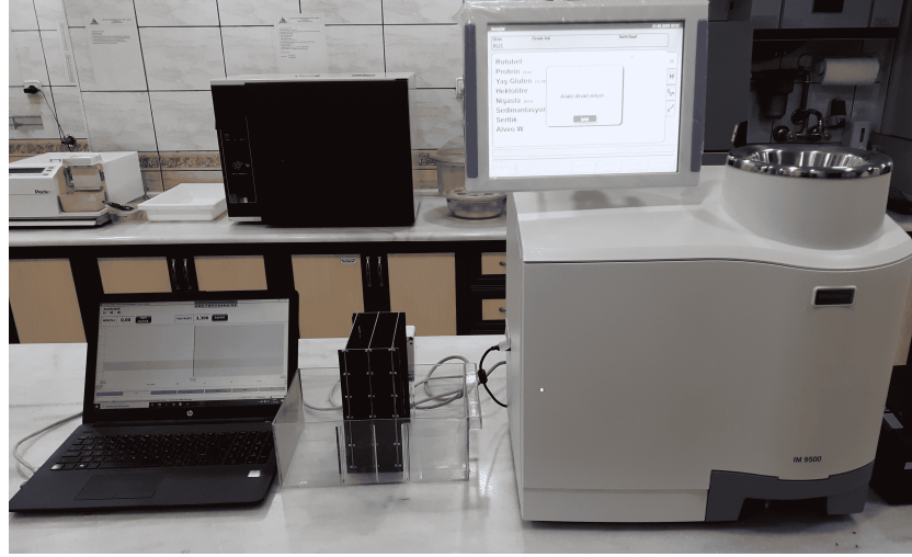
Şekil 3.3. Labaratuvar nem(%)/hektolitreye(kg/h) ölçüm düzeneği
