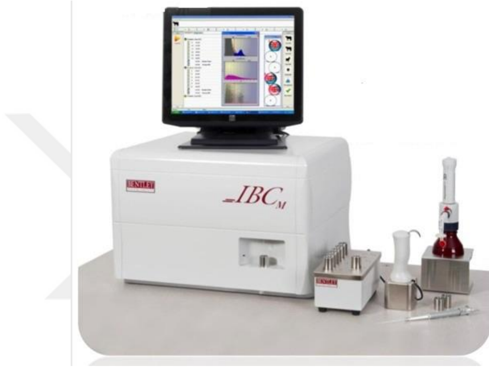
Resim 3.1. Bentley BactoCount IBCm somatik hücre ve toplam bakteri ölçüm cihazı
