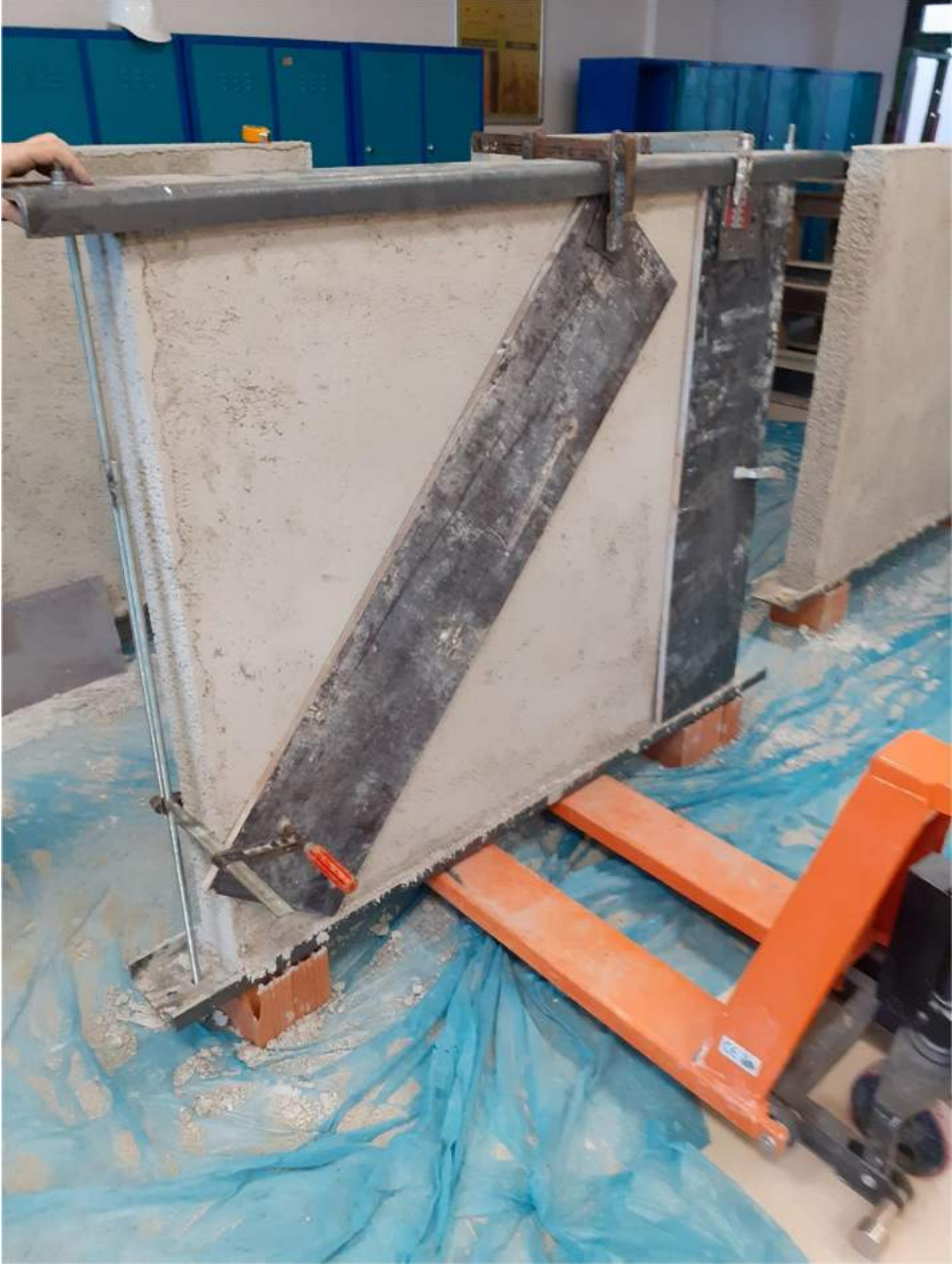
Şekil 4.3: Her iki ucu yivli tijli deney numuneleri
