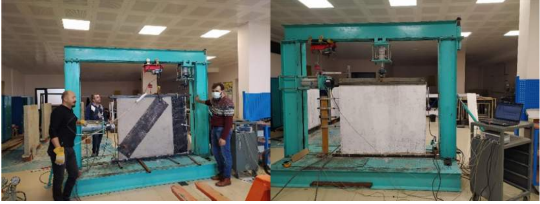
Şekil 4.10 Deney numunesi düzeneğe yerleştirilmesi
