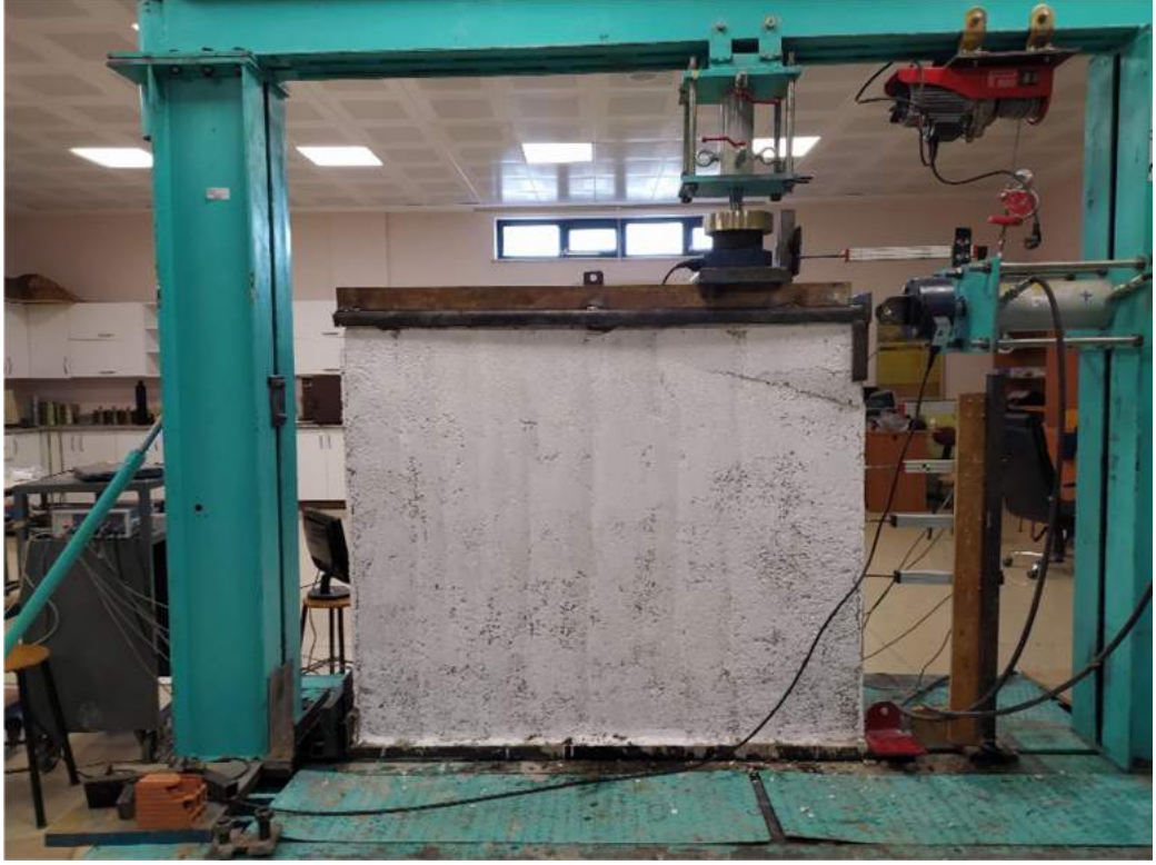
Şekil 4.14: Deney sonu hasar durumu
