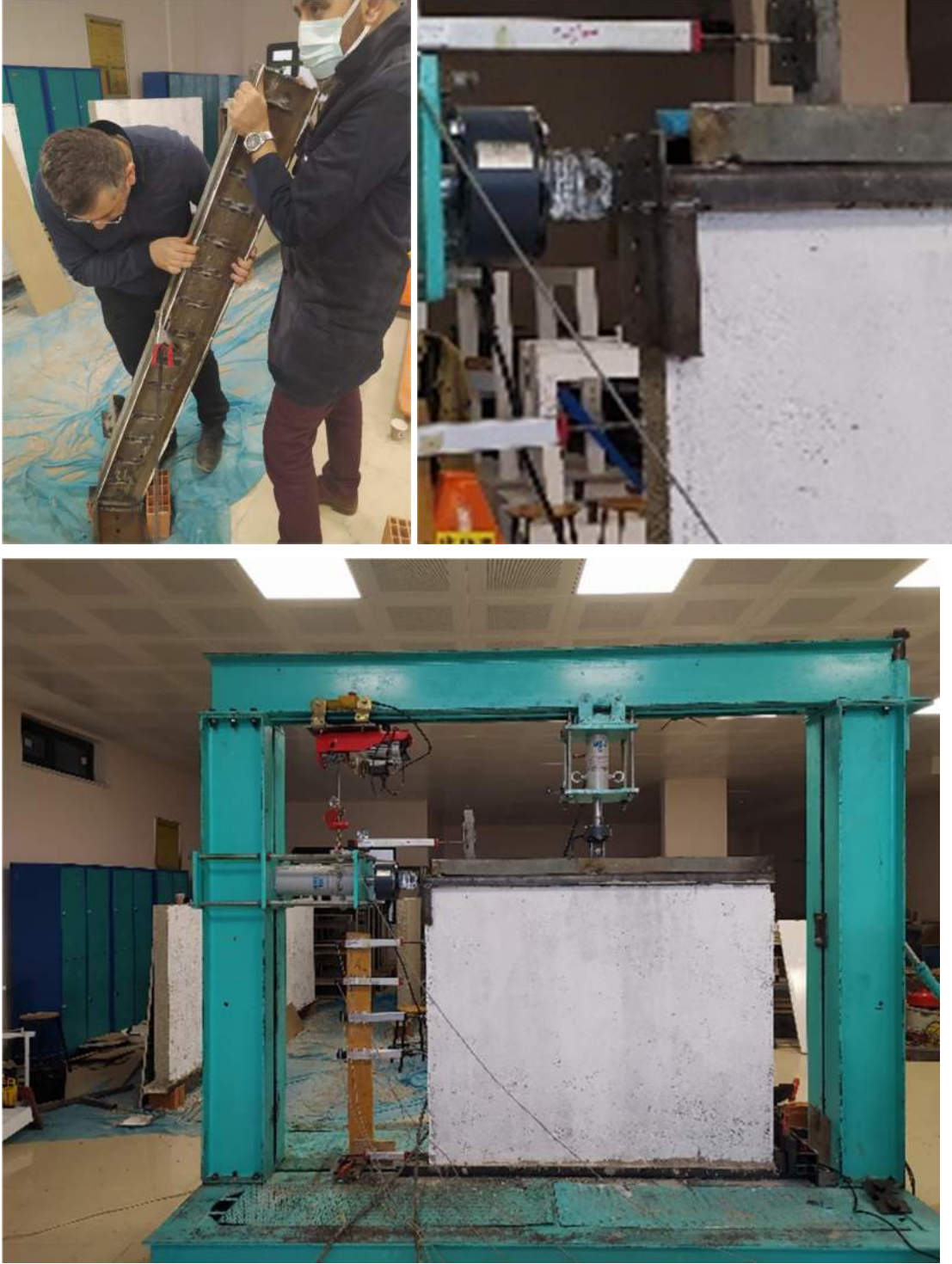
Şekil 4.13: Yükleme sisteminde yapılan değişiklik
