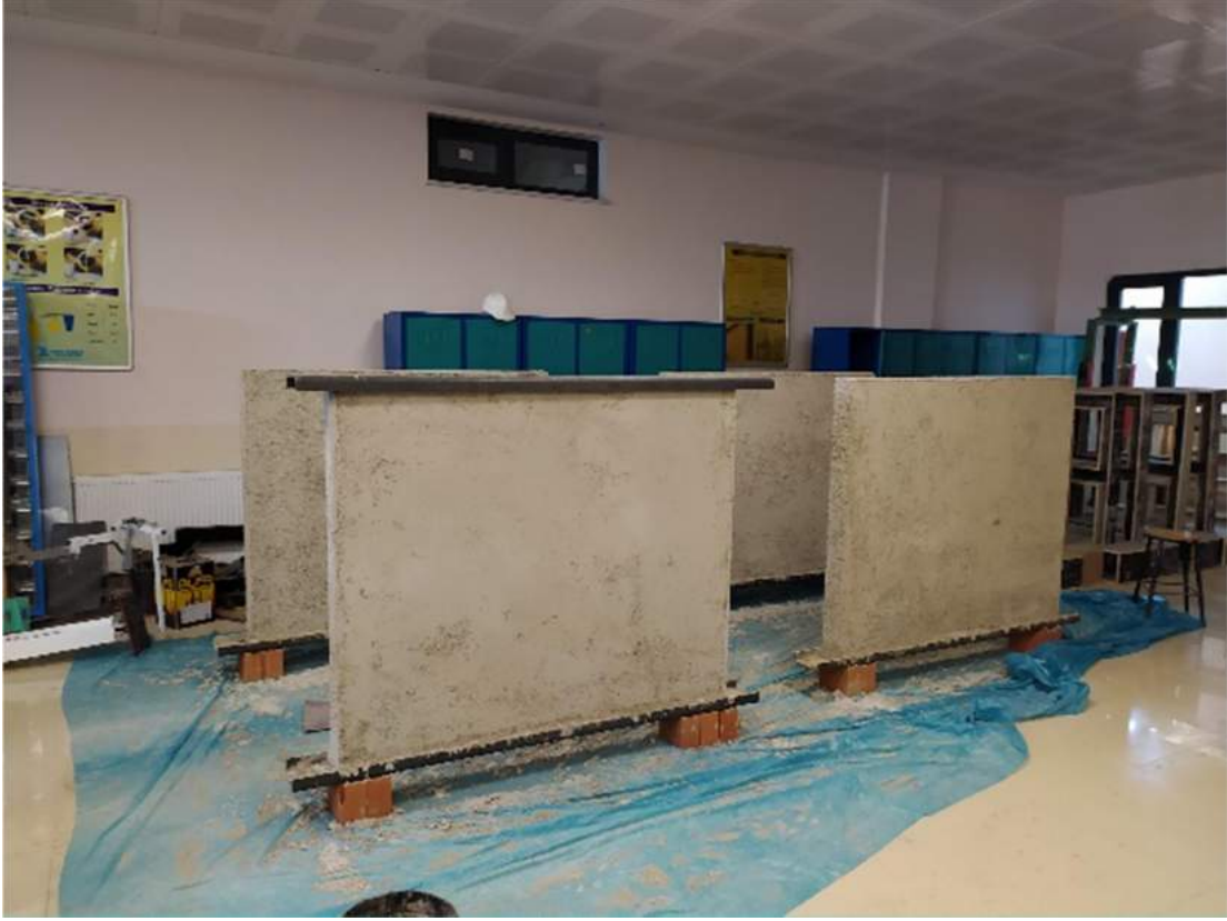
Şekil 4.4: Üretilen tuğla duvar deney numuneleri
