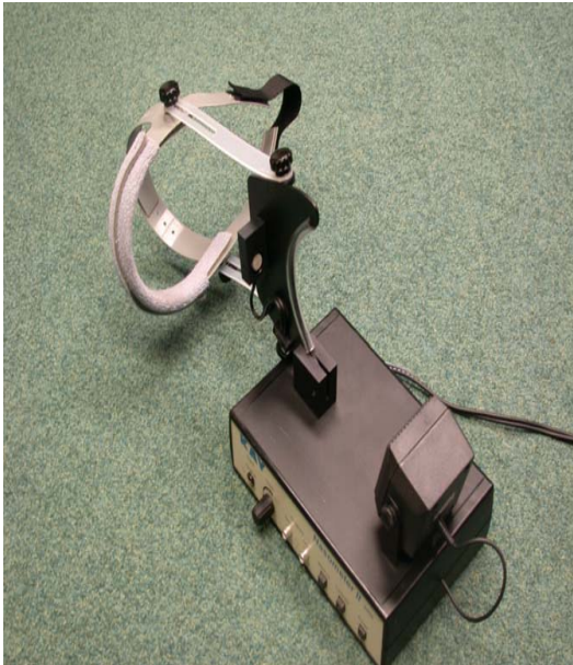
Resim 4 a, b: Nazometre II Model 6400 cihazı ve Nazal ve Oral yolları birbirinden ayıran test başlığının uygulanışı
