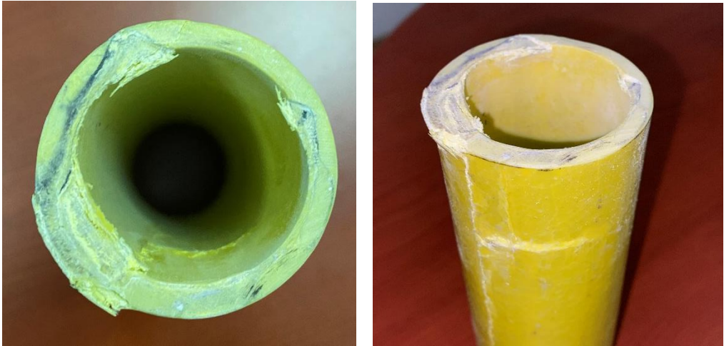
Şekil 5.29. 700 mm 2 kesit alanlı dairesel kesitli profil numunesi basma deneyi
