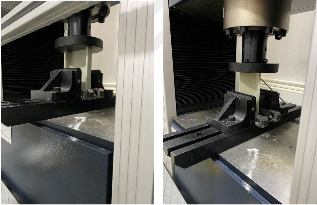
Şekil 4.5. Basma deneyi yapılan U profil ve köşebent profil numunesi
