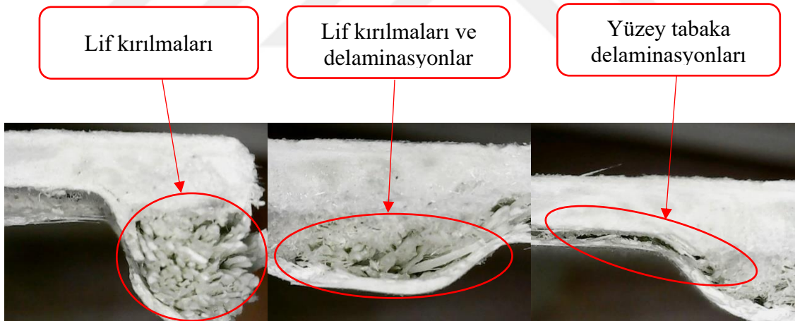
Şekil 5.40. 330 mm 2 kesit alanlı trapez profil hasar görüntüleri
