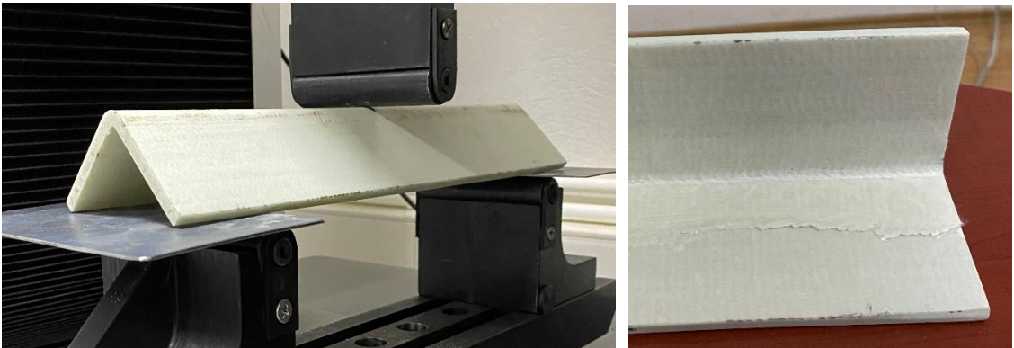
Şekil 5.13. 700 mm 2 kesit alanlı köşebent profil numunesi eğilme deneyi
