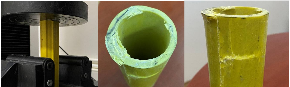
Şekil 5.20. 330 \text{ mm}^2 kesit alanlı tırtıklı dairesel kesitli profil numunesi basma deneyi
