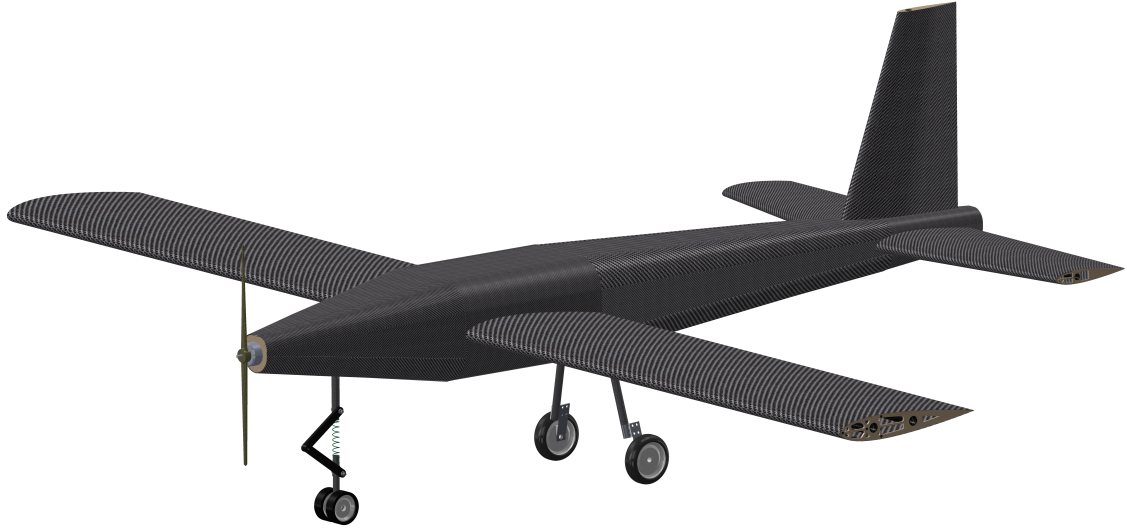
Şekil 3.7. Tasarlanan mini İHA'nın nihai genel montajının CAD görünümü.
