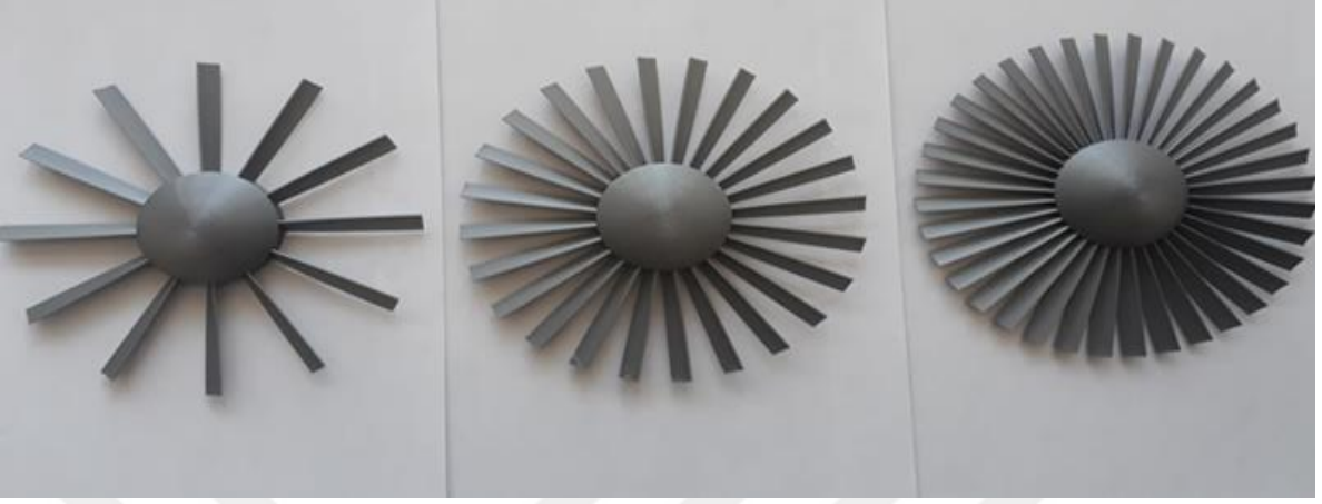
Şekil 4.3. Üç boyutlu yazıcı ile basılan rüzgar türbini modelleri (12, 24, ve 36 kanat sayılı)
