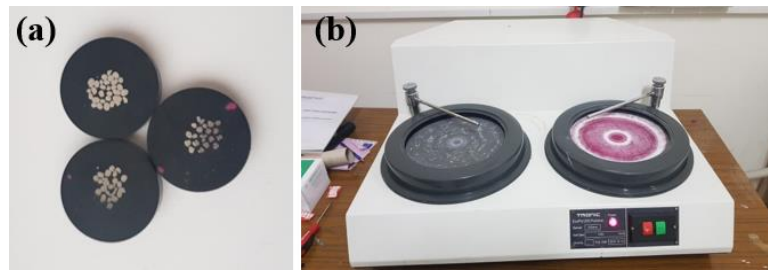
Şekil 4. 4. (a) Bakalite alınarak zımparalanan numune ve (b) Tronic Ecopol 200 Polisher çift diskli zımparalama ve parlatma cihazı
