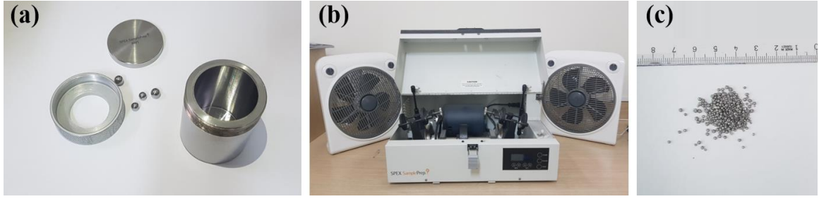
Şekil 4. 2. (a) SPEX 8001 marka sertleştirilmiş çelik öğütme haznesi, (b) SPEX 8000D marka yüksek enerjili bilyalı değirmen ve (c) YEMÖ sonrası toz boyutları
