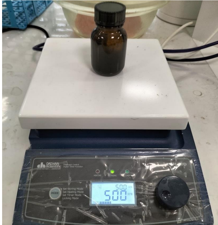
Şekil 3.1. Manyetik Karıştırıcı ile Yapıştırıcıların Hazırlanması Süreci
