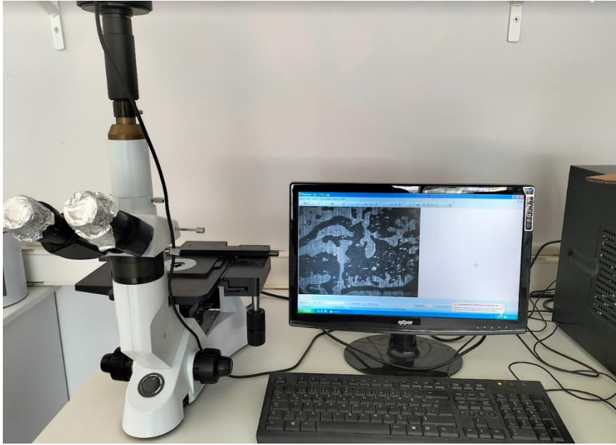
Şekil 3.13. Mikroskop ile Yapışma Yüzeylerinin İncelenmesi
