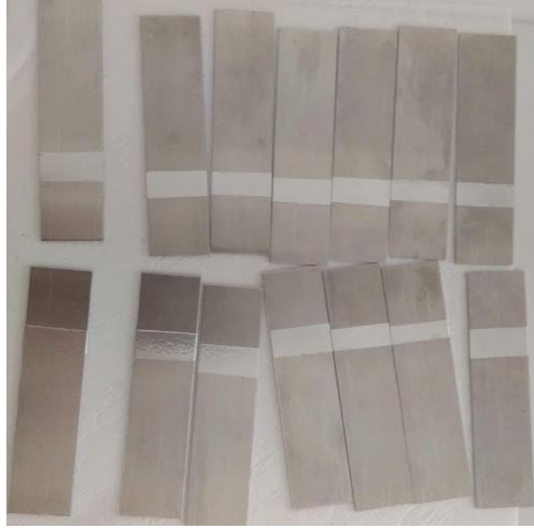
Şekil 3.3. Yapıştırma İşlemi Öncesi Alüminyum Levhaların Hazırlanması
