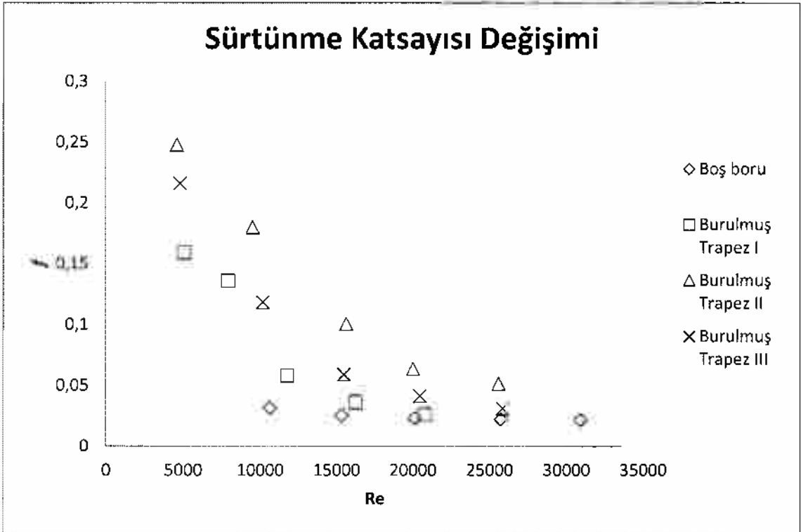
Şekil 4.56 Reynolds sayısına göre sürtünme faktörlerinin değişimi
