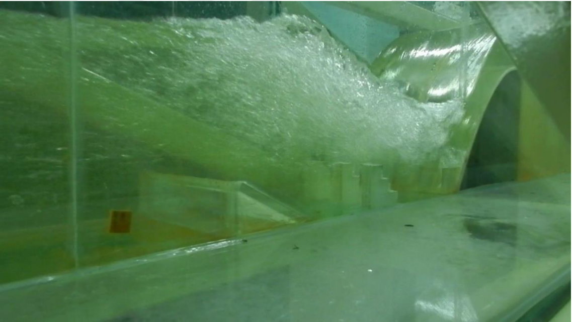
Şekil 4.15 Basamak kesitli tek sıra enerji kırıcı blokların yerleşim şekli
