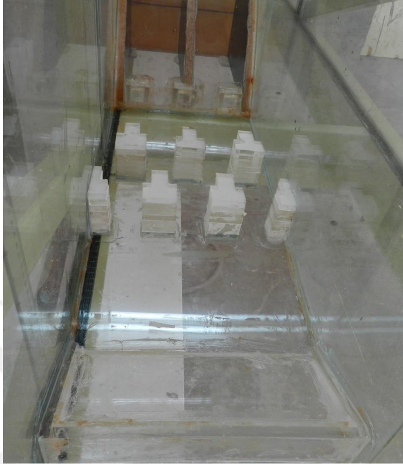
Şekil 4.16. T şekilli çift sıra enerji kırıcı blokların yerleşim şekli
