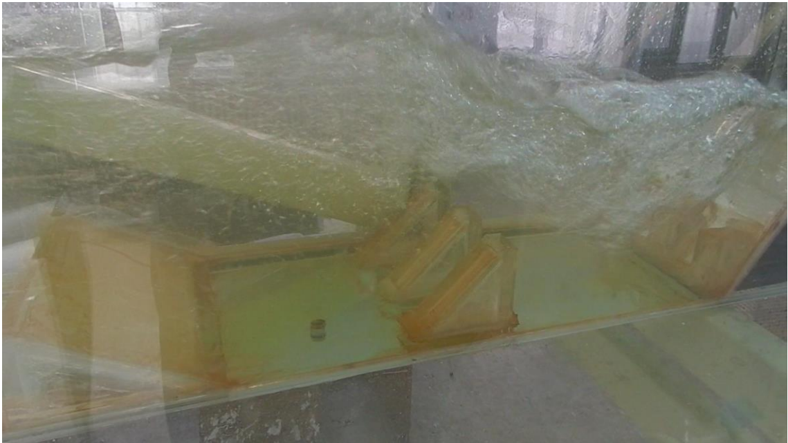
Şekil 4.13. Trapez kesitli tek sıra enerji kırıcı blokların yerleşim şekli
