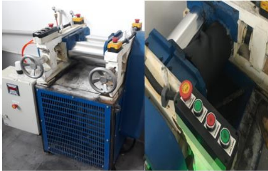
Şekil 5.3. Laboratuvar tipi iki silindirli karıştırıcı
