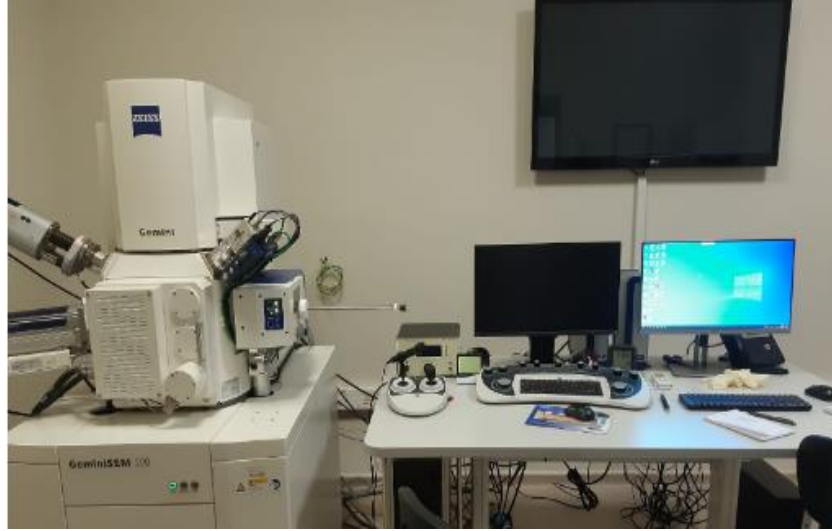
Şekil 6.2. Alan emisyonlu taramalı elektron mikroskop cihazı.
