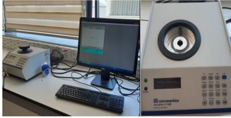
Şekil 6.4. Gaz Piknometre ünite sistemi
