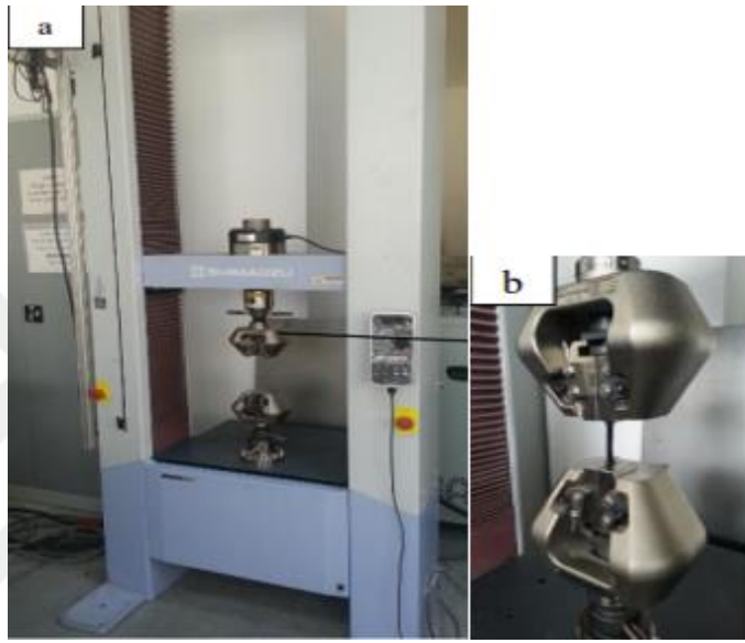
Şekil 6.6.a) Deneysel çalışmada kullanılan çekme cihazı b) Çekme çenesi [145].
