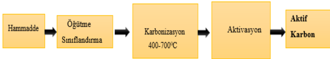
Şekil 3.8. Fiziksel aktivasyon yöntemiyle aktif karbon üretim akım şeması [74].
