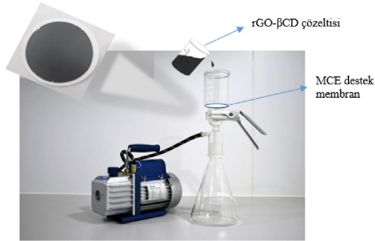
Şekil 3.3. Membran filtrasyon şeması
