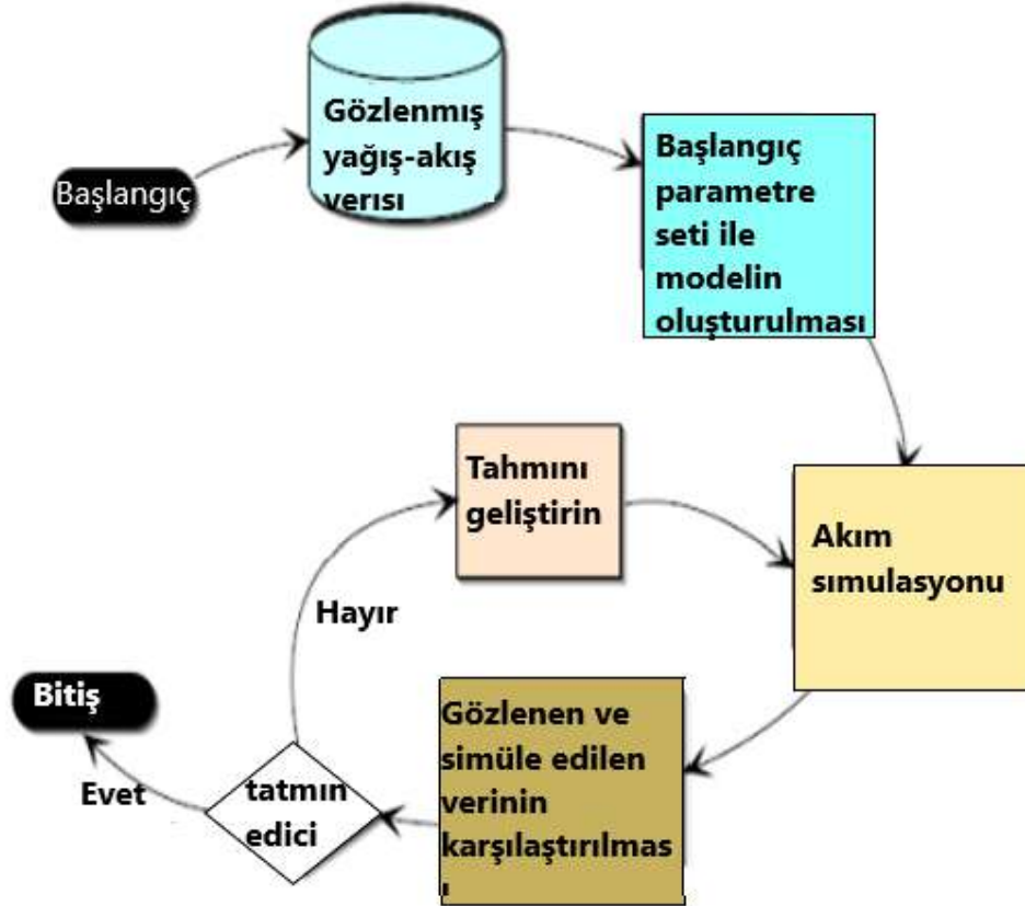
Şekil 3.6. Kalibrasyon prosedürünün şeması (USACE, 2000)
