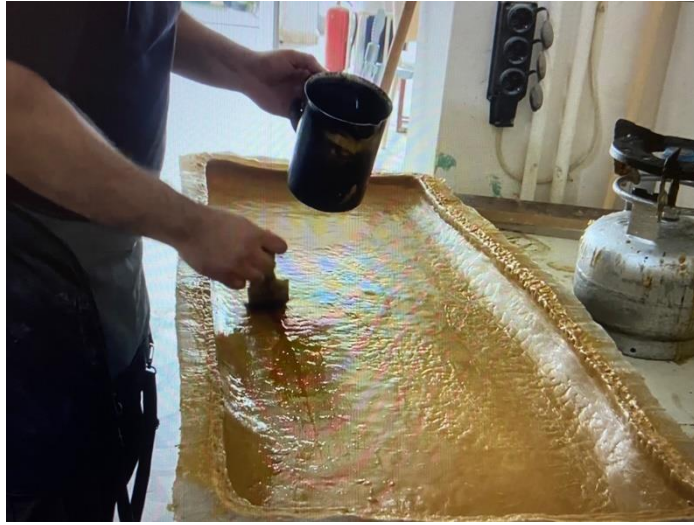
Resim 13: Silikon Kalıba Sıvı Halde Balmumu Sürülerek Heykel Model Üretimi
