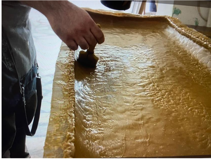
Resim 15: Silikon Kalıba Sıvı Halde Balmumu Sürülerek Heykel Model Üretimi
