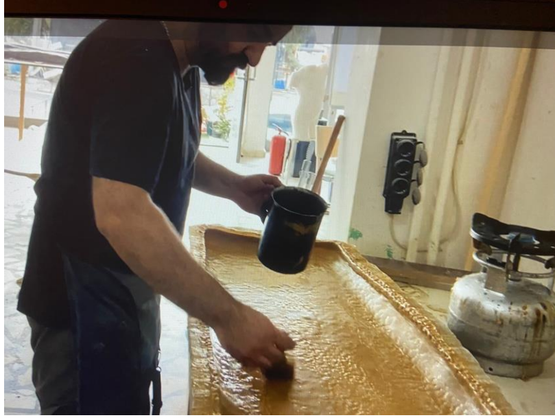
Resim 14: Silikon Kalıba Sıvı Halde Balmumu Sürülerek Heykel Model Üretimi
