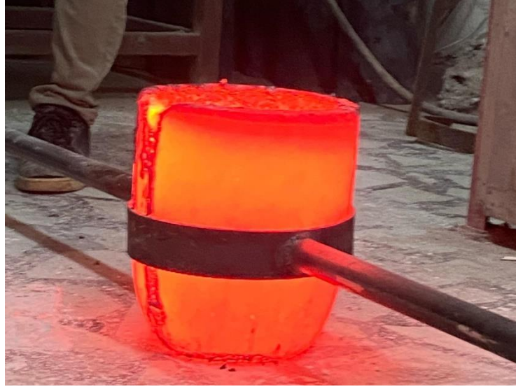
Resim 24: Atölye Çalışmaları Eritilmiş Bronzun Kalıba Dökümü
