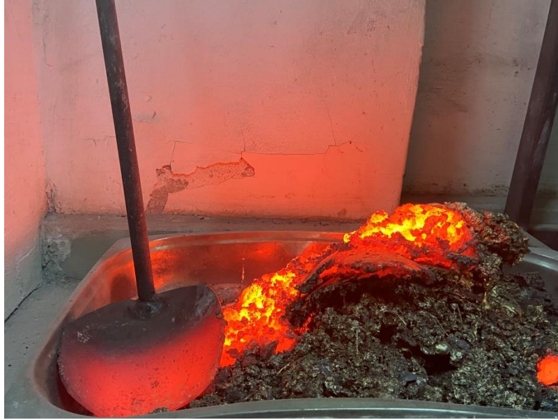
Resim 19: Erimiş Bronzdan Çıkarılan (Curuh) Kaba ve Atıl Maden
