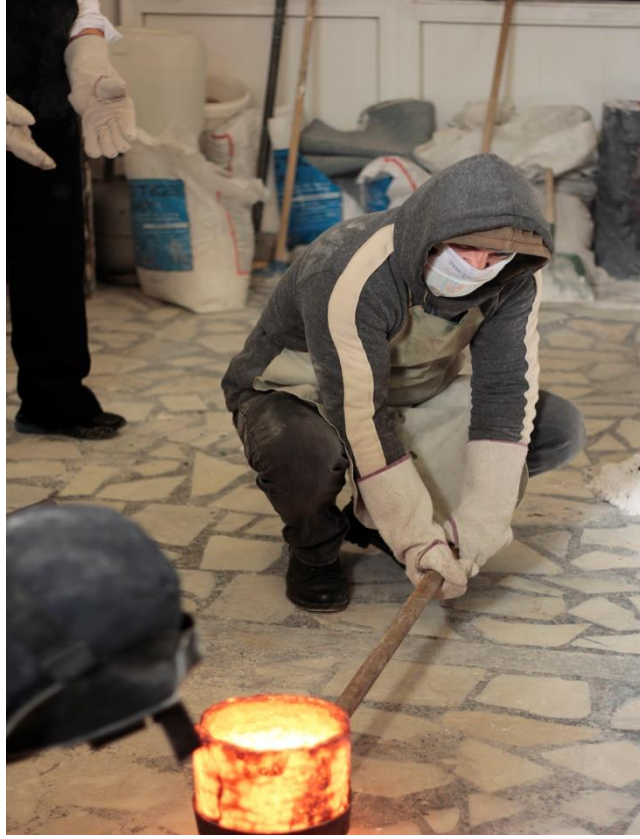
Resim 23: Atölye Uygulamaları Grafit Pota İçerisinde Eritilmiş Bronz
