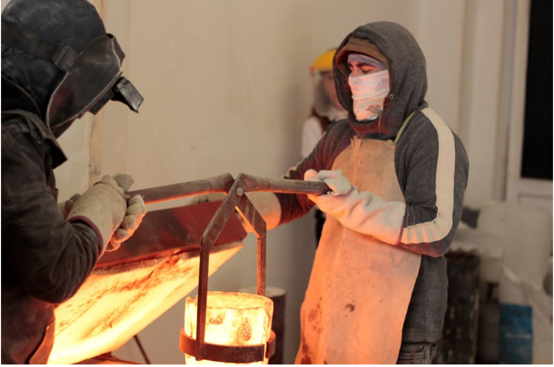
Resim 22: Atölye Çalışması Erimiş Bronzun Eritme Ocağından Çıkartılması
