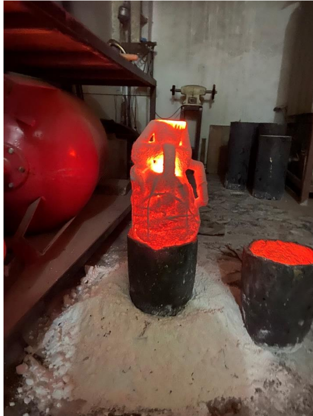
Resim 25: Seramik Kalıba Dökülmüş Bronz
