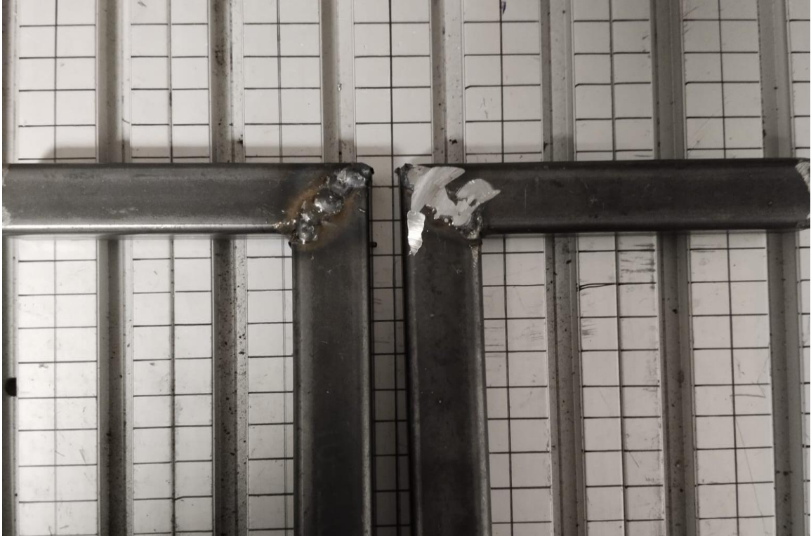
Şekil 4.23 Birden fazla bağımsız taşlama prosesi sonrası aynı kaynak dikişine sahip profilin değişim görüntüsü örneği
