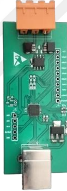
Şekil 3.10 RS485-UART dönüştürücü devresi
