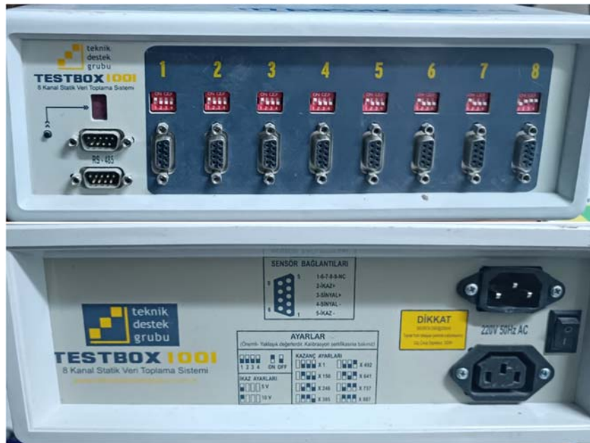
Şekil 4.2. Strain-gage verilerini almak için kullanılan Testbox veri toplama cihazı.
