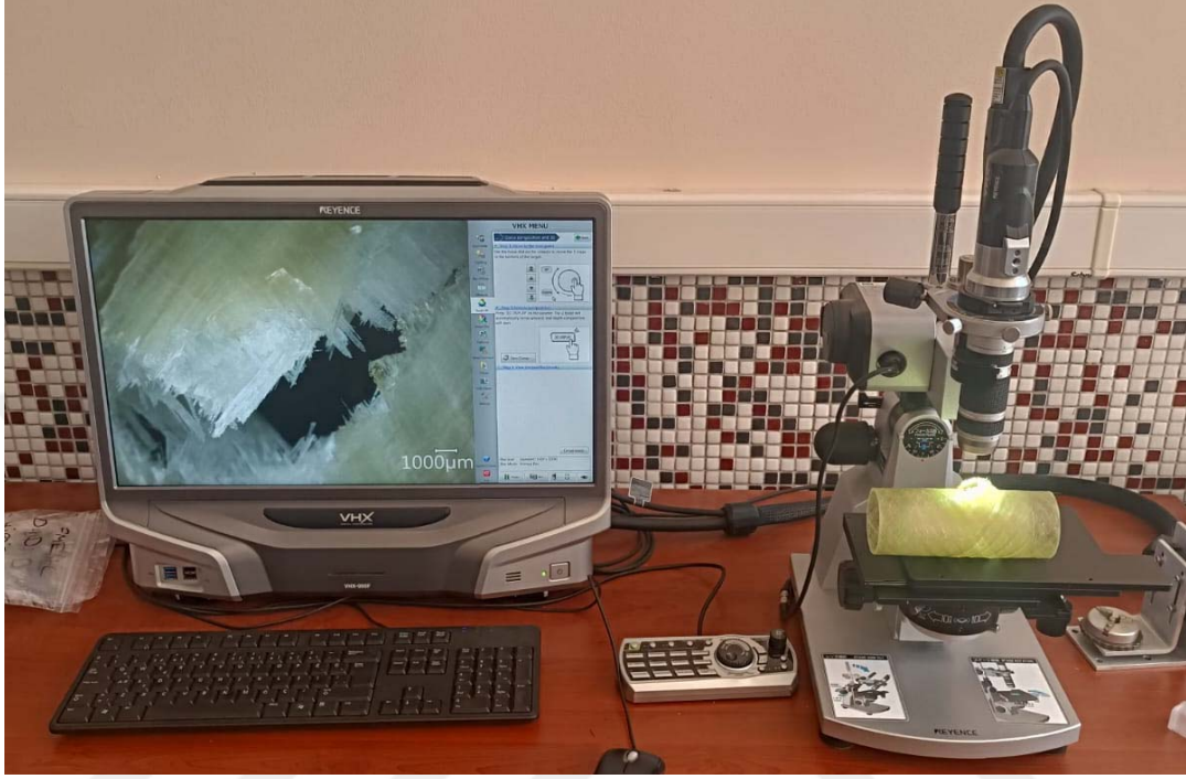
Şekil 4.7. Patlatma numunesinin optik mikroskopta incelenmesi.
