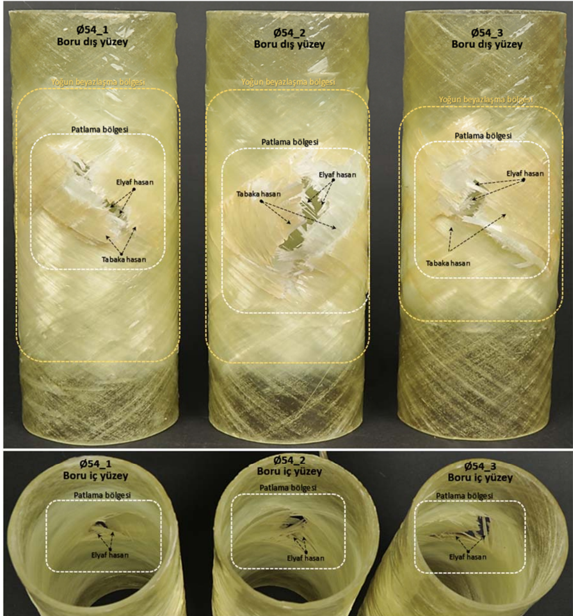
Şekil 5.5. Ø54 CTP kompozit borularda patlatma testi sonrası makro hasar analizleri.
