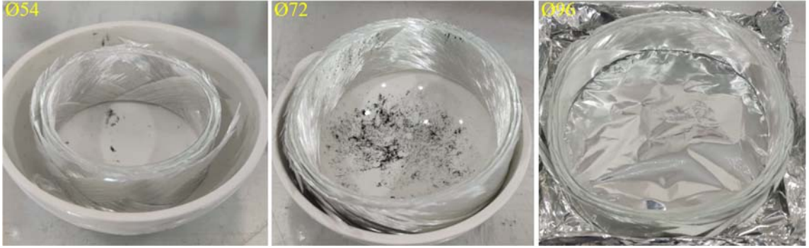
Şekil 5.1. Farklı çaplardaki CTP borulara uygulanan yakma testi sonrasındaki görüntüler.
