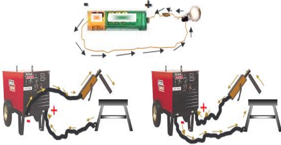
Şekil 3.5. AC ve DC Kaynak makine örnekleri
