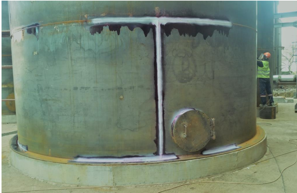
Şekil 4.3b. Kaynak Panetrant Testi
