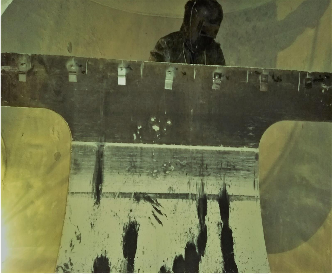
Şekil 4.15. 1.Batarya 1.aparat içerisinde konulan St37-2, AISI 304, AISI 316, Monel 400, Hastelloy C22 ve Hastelloy C276 kuponlar
