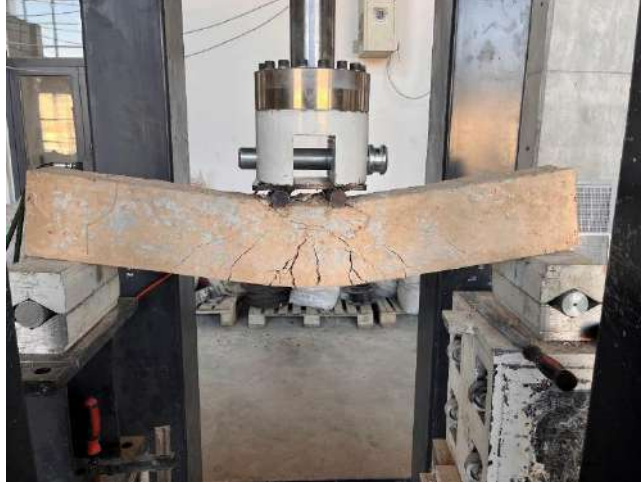
Şekil 4.47. Ref 10K-10 isimli numunede gözlemlenen eğilme çatlakları
