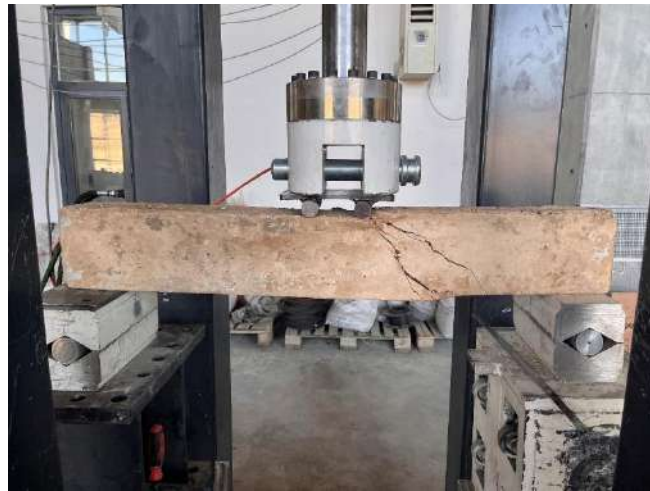
Şekil 4.46. C 10K-16 isimli numune gözlemlenen kesme çatlığı
