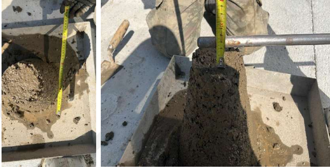
Şekil 4.8. Döküm öncesi slump deneyleri
