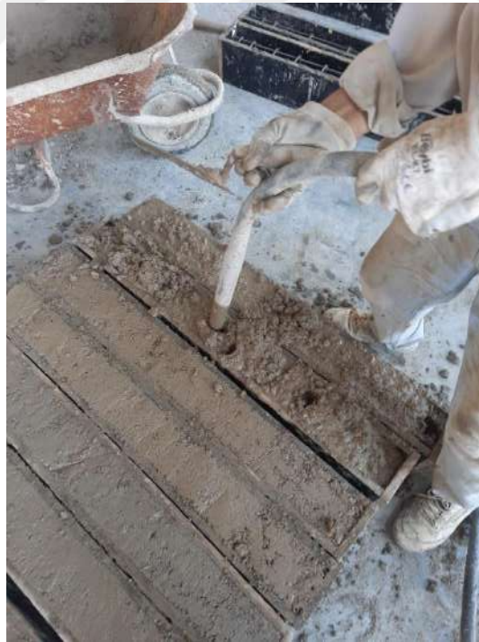
Şekil 4.9. Vibratörle harcın kalıplara yerleştirme işlemi
