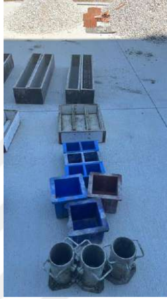
Şekil 4.6. 1 set farklı numuneler için hazırlanmış kalıplar
