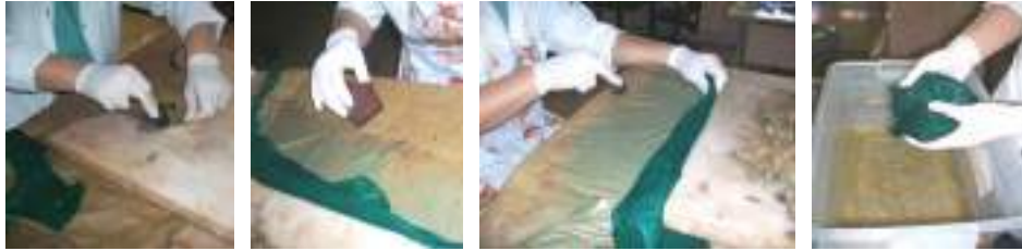
Resim 2.124. Islakderinin bıçkı ile tıraşlanması
