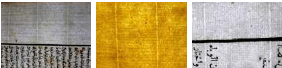
Resim 2.6. Türk beşikdevri basmalarında laid line ve chain line (BB0000014615, BB0000000396, BB0000000327).
