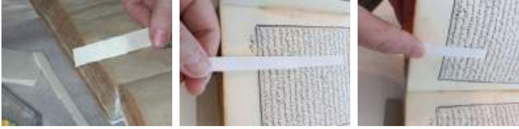
Resim 2.47. Saplamalarla forma ortalarının işaretlenmesi.
