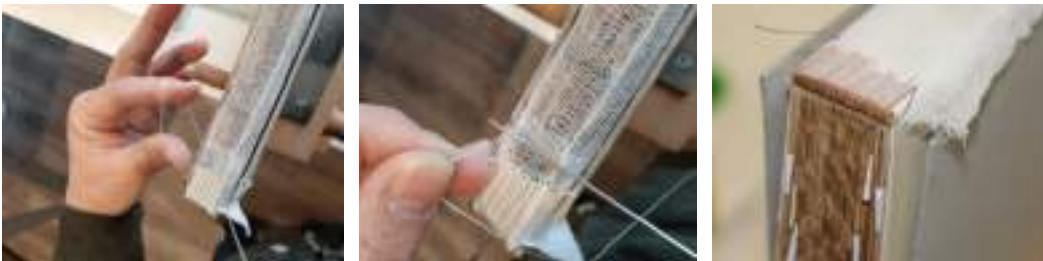
Resim 2.51. Kolon atımının tamamlanması.
