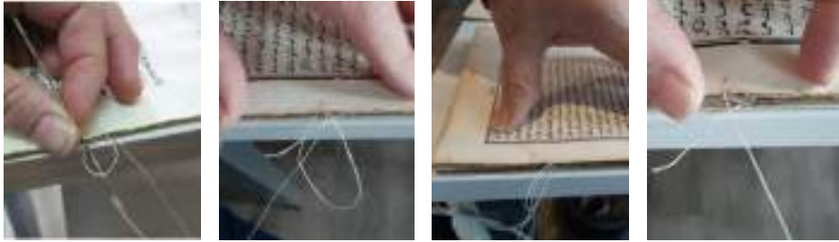
Resim 2.24. İki duraklı zincir dikişte düğüm atılması.
