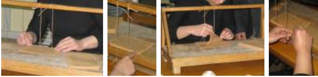
Resim 2.32. Tezgâhta sırt dikişi işlemi.
