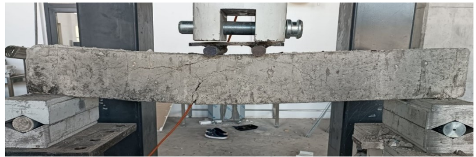
Şekil 4.20. \phi 8 , \phi 10 ve \phi 12 çekme donatılı, referans ve PET katkıli betonarme kirişlerin kırılma biçimleri
