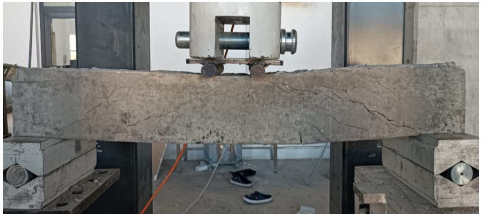
Şekil 4.20. \phi 8 , \phi 10 ve \phi 12 çekme donatılı, referans ve PET katkıli betonarme kirişlerin kırılma biçimleri
