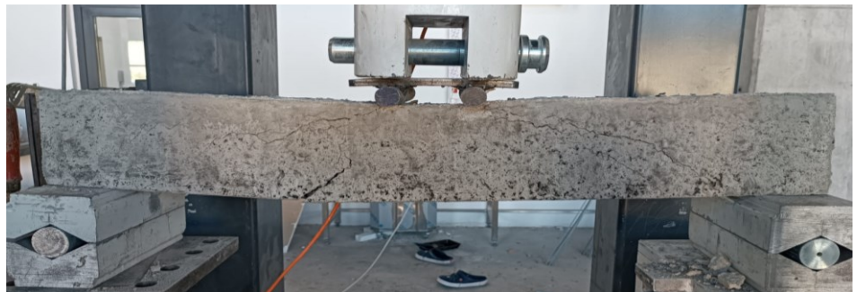
Şekil 4.20. \phi 8 , \phi 10 ve \phi 12 çekme donatılı, referans ve PET katkılı betonarme kirişlerin kırılma biçimleri
