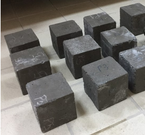
a) Basınç deneyi için hazırlanan numuneler
