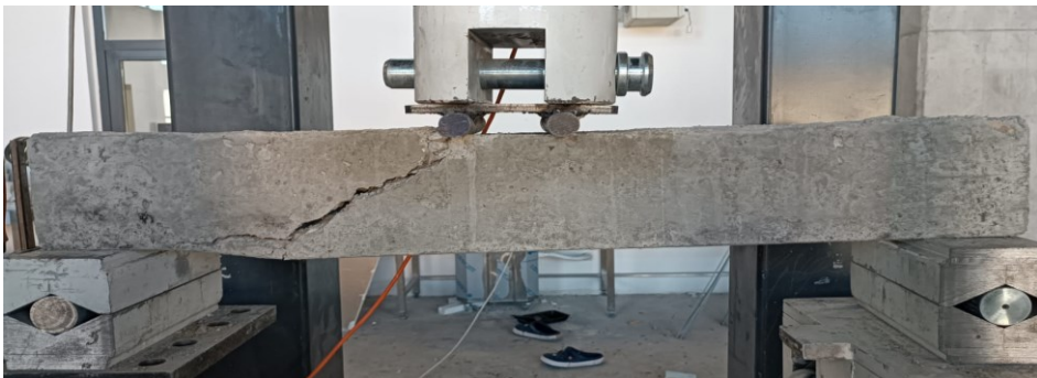
Şekil 4.23. \phi 8/16 , \phi 8/20 ve \phi 8/27 etriyeli referans ve PET katkılı kirişlerin kırılma biçimleri
