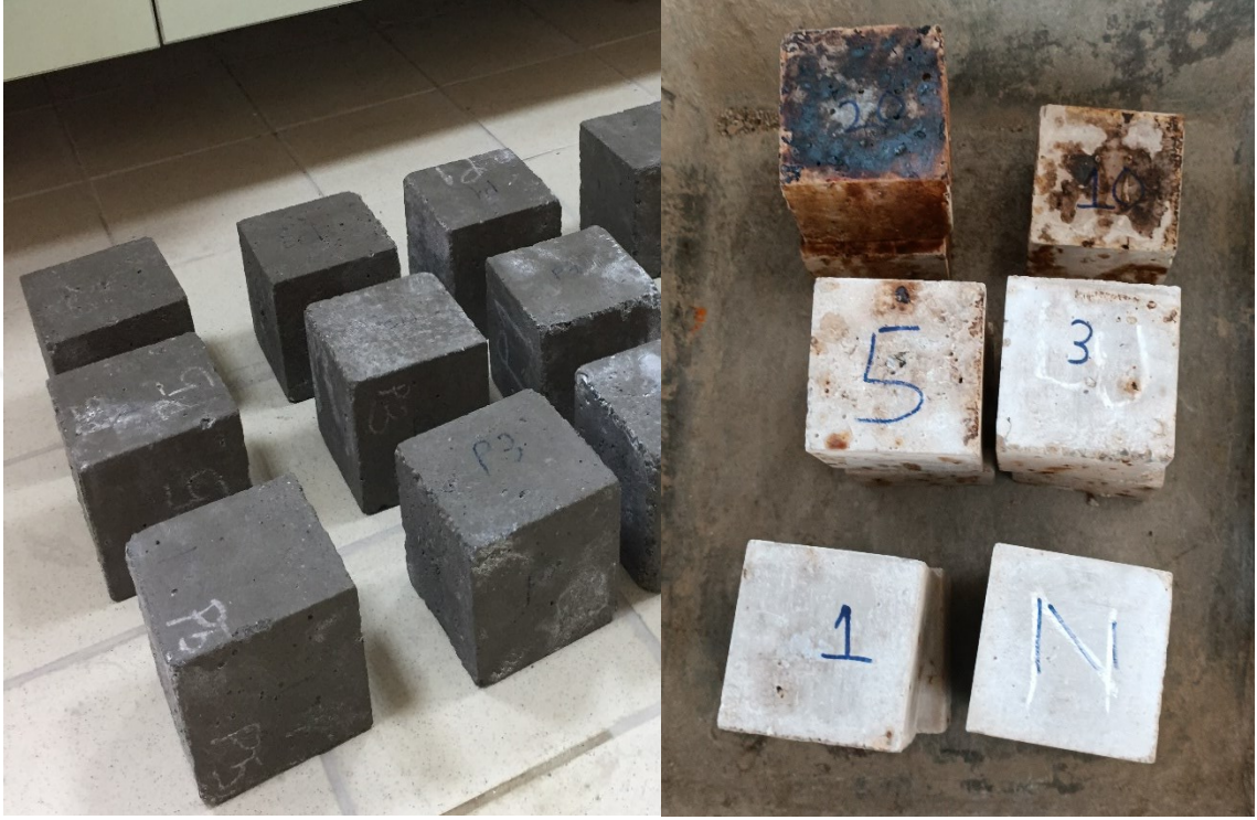
Şekil 3.6. Farklı sıcaklıklara maruz bırakılmadan önce hazırlanan numuneler (ref. için 10 cm küp beton ve PET içerikli) (sol) ve 300 °C'ye maruz bırakıldıktan sonra referans ve PET modifiye edilmiş numuneler (sağ)
