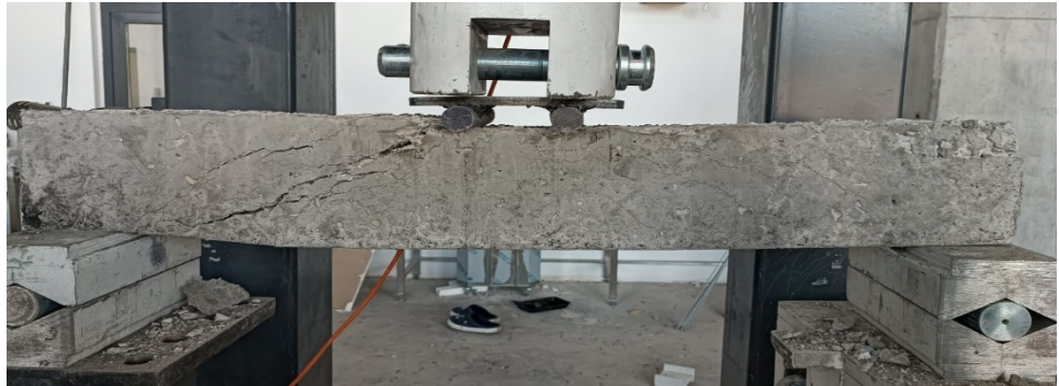
Şekil 4.20. \phi 8 , \phi 10 ve \phi 12 çekme donatılı, referans ve PET katkıli betonarme kirişlerin kırılma biçimleri
