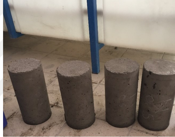
b) Yarmada-çekme deneyi için hazırlanan numuneler
