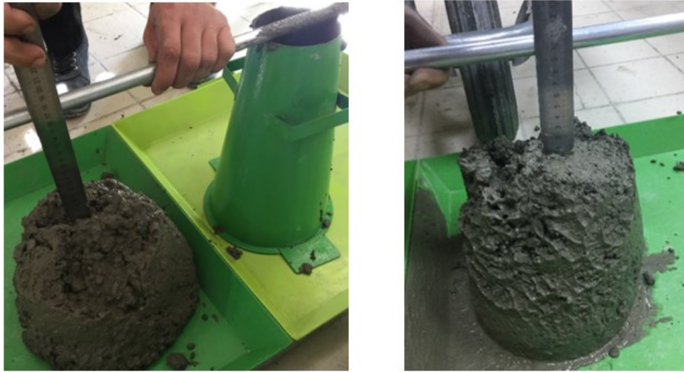
Şekil 4.1. Konik döküm beton numunesinin çökme davranışına ilişkin çökme ölçümü örneği
