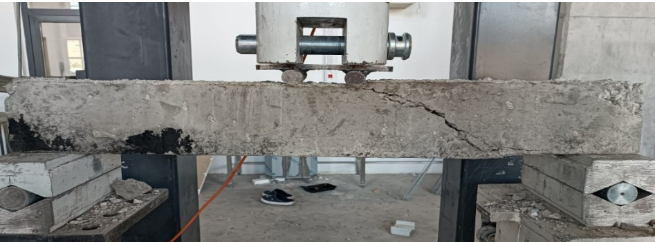
Şekil 4.23. \phi 8/16 , \phi 8/20 ve \phi 8/27 etriyeli referans ve PET katkıli kirişlerin kırılma biçimleri
