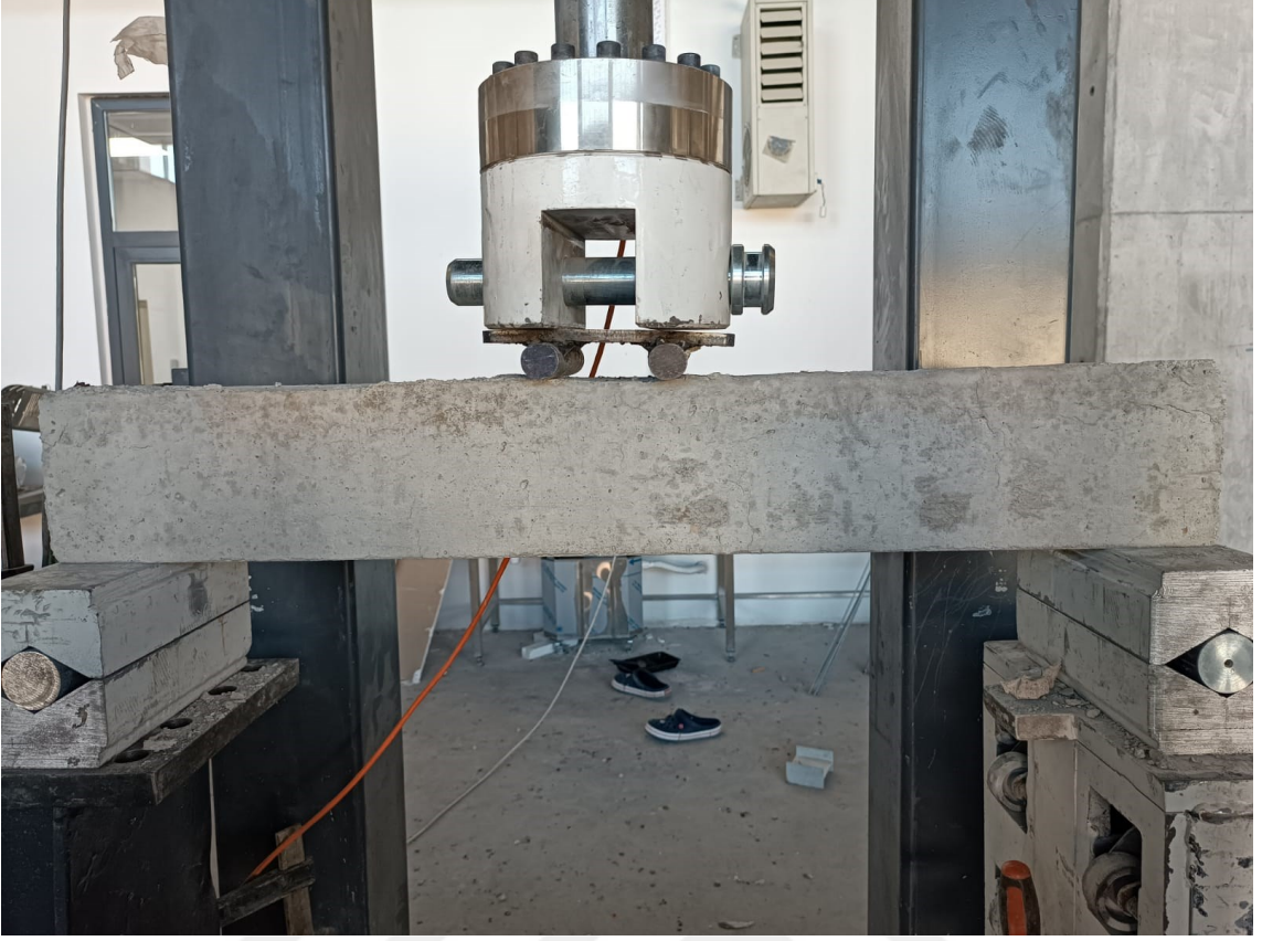
Şekil 3.13. Eğilme testleri için dört noktalı yükleme düzeneği
