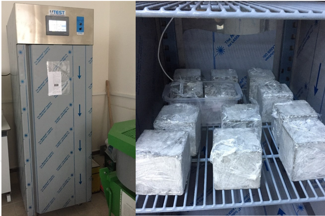
Şekil 3.7. Donma-çözülme kabini (Sol) ve kabindeki numunelerin düzenlenmesi (sağ)
