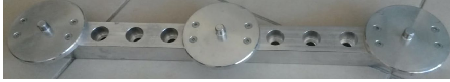
Şekil 6.4 Alıcıların sehpa üzerine yerleştirilmesini sağlayan aparat
