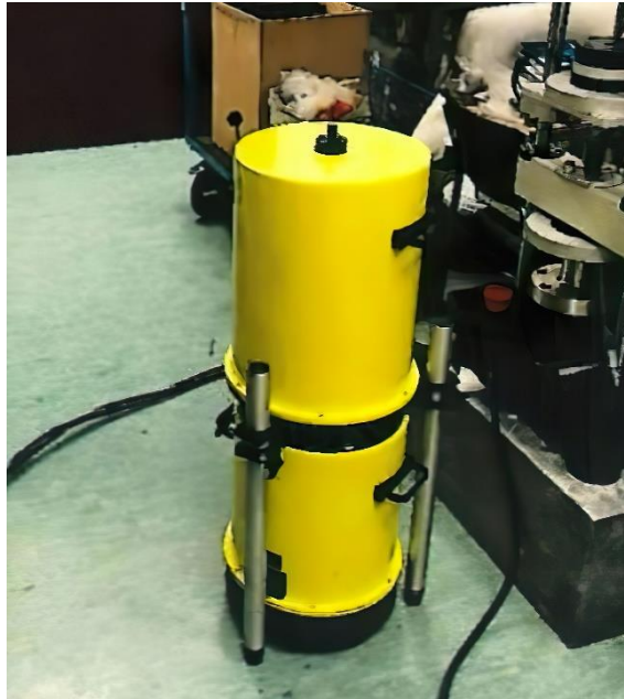
Şekil 4.5. Mutlak gravimetre cihazı ile yerel yer çekimi ivme değeri belirleme çalışması
