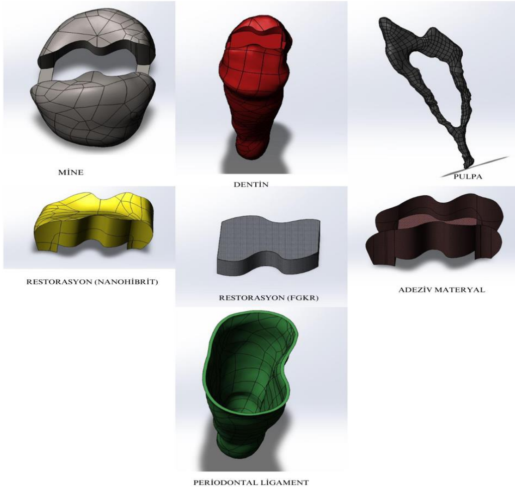
Şekil 8. Solidworks programında oluşturulan maksiller 2. premolar diş modeli
