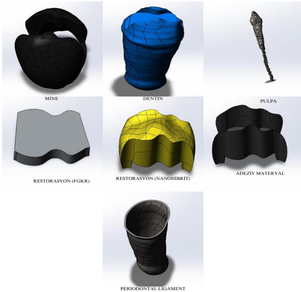
Şekil 5. Solidworks programında oluşturulan mandibular 1. premolar diş modeli
