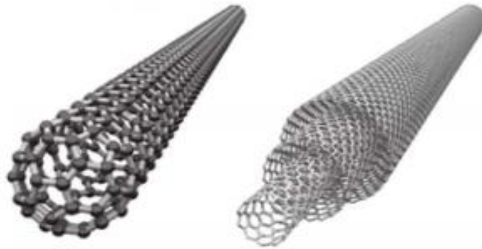
Şekil 2. Tek Duvarlı ve Çok Duvarlı Karbon Nanotüp (Cividanes et al., 2014)
