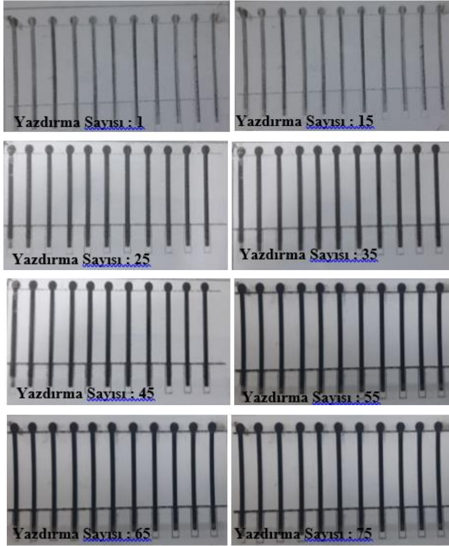
Şekil 12. 20 mg/ml \text{SO}_3\text{H-N-MWCNT} -30 dk BM konsantrasyonuna sahip 0.2 mg/ml SDS içeren mürekkep karışımının plazma ile temizlenmiş PET altlıklar üzerine 75 kat yazdırılması sonucu elde edilen dijital resimler.
