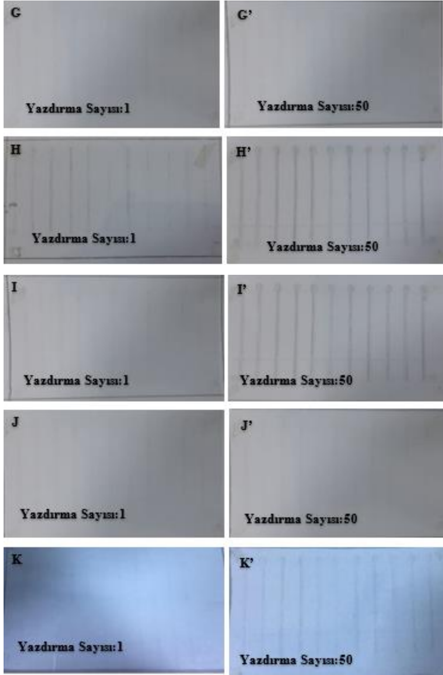
Şekil 9. 4 mg/ml ; 10 mg/ml ; 20 mg/ml konsantrasyonlarına sahip SDS içermeyen A-E: MWCNT, SO 3 H-MWCNT , N-MWCNT , SO 3 H-N-MWCNT , SO 3 H-N-MWCNT-0 dk BM ; F-G-H-I : SO 3 H-N-MWCNT-5 dk BM , SO 3 H-N-MWCNT-10 dk BM , SO 3 H-N-MWCNT-45 dk BM , SO 3 H-N-MWCNT-60 dk BM ; J-K: SO 3 H-N-MWCNT-15 dk BM , SO 3 H-N-MWCNT-30 dk BM mürekkeplerin PET altlıklar üzerine yazdırılması sonrası elde edilen dijital resimler .
