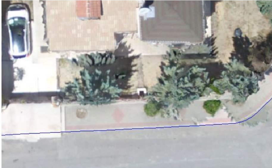
Şekil 5.34. Eğik Nokta bulutundan kutur ölçümü
