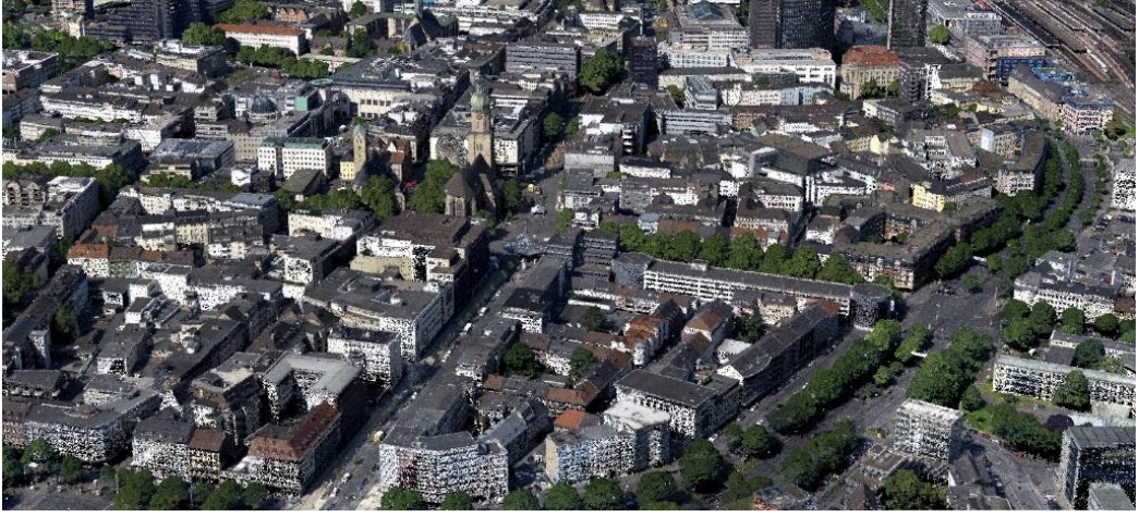
Şekil 4.9. Almanya'nın Dortmund şehrinde IGI DigCAM Penta ile eğik olarak çekilmiş görüntüler ile oluşturulmuş nokta bulutu (URL9)
