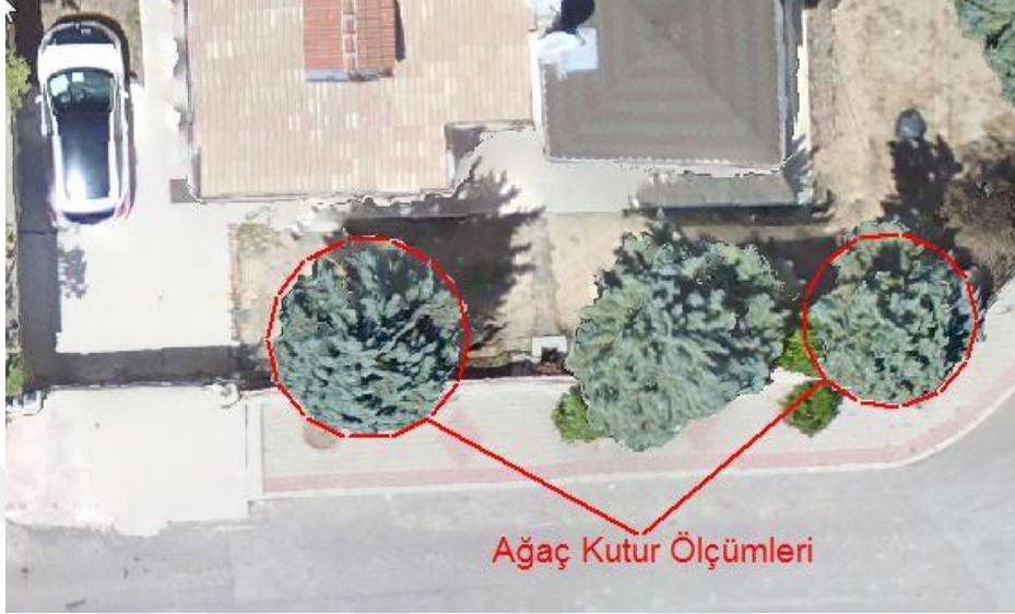
Şekil 5.33. Eğik Nokta bulutundan kutur ölçümü
