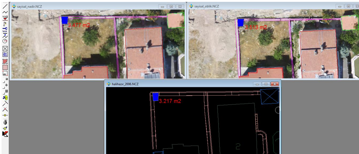
Şekil 5.48. Seçilen binaya ait alan değerleri ölçüm örneği
