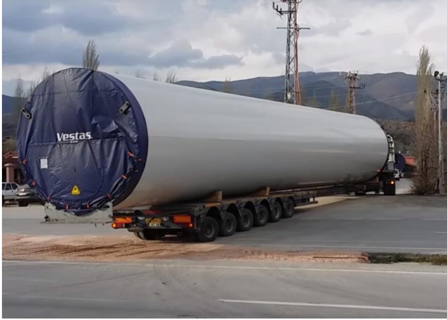
Şekil 1.8. Rüzgar Türbin Parçalarının İnşaat sahasına Taşınması
