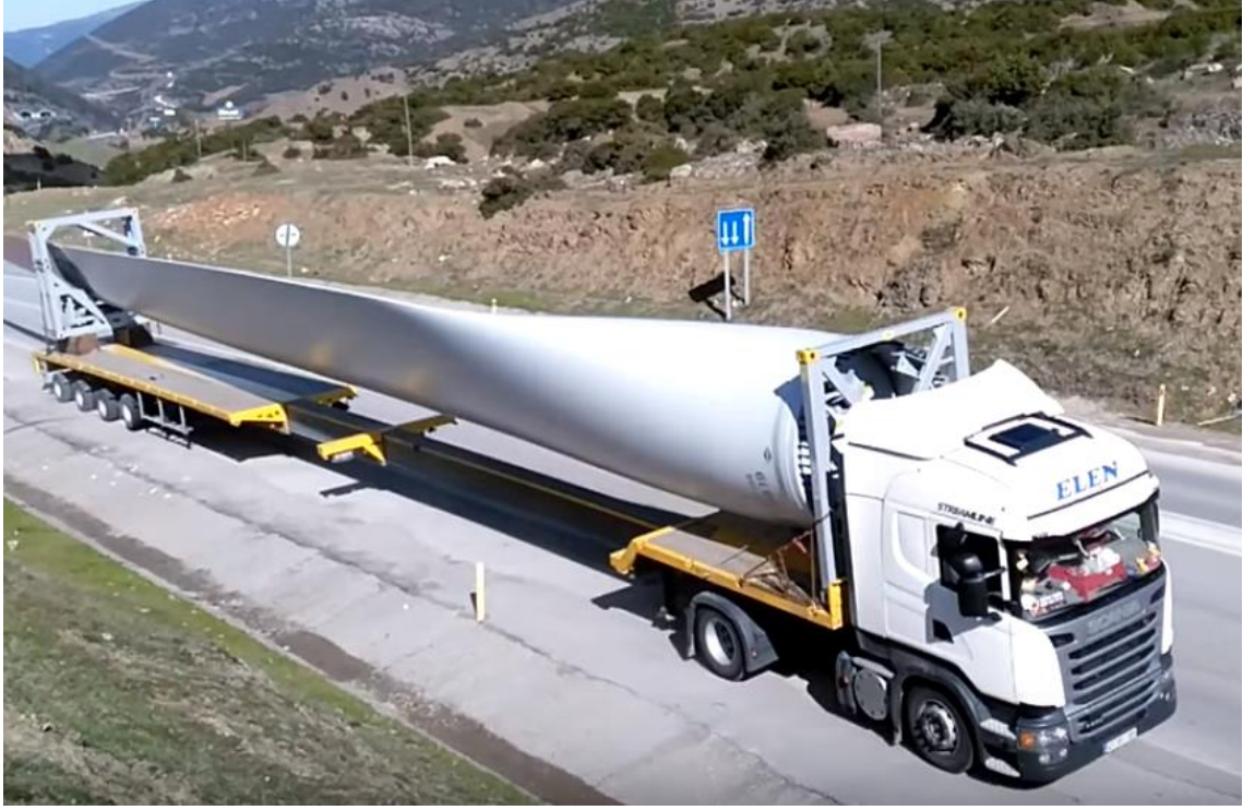
Şekil 1.7. Rüzgar Türbin Kanadının İnşaat sahasına Taşınması
