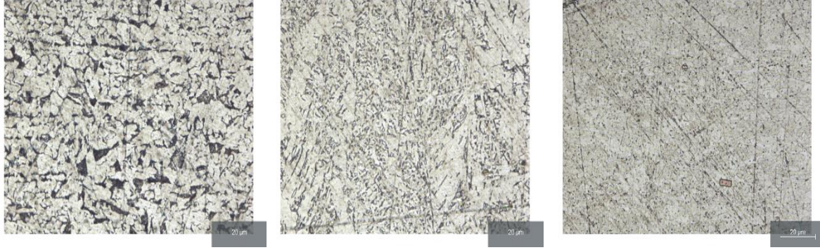
a) S355JR esas metal-ITAB geçişi b) Kaynak metali c) S700MC esas metal-ITAB geçişi Şekil 7.12. S355JR-S700MC çeliğinin HB 212 karışım gazıyla MAG kaynağında mikroyapı incelemeleri
