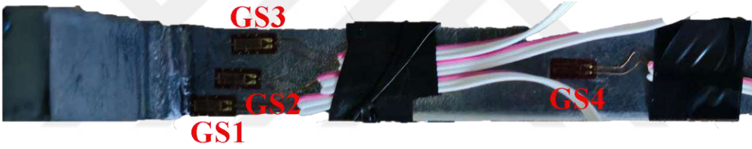
Şekil 3.33. SP-90-S960-HFMI-15 numunesine yapıştırılmış GS
