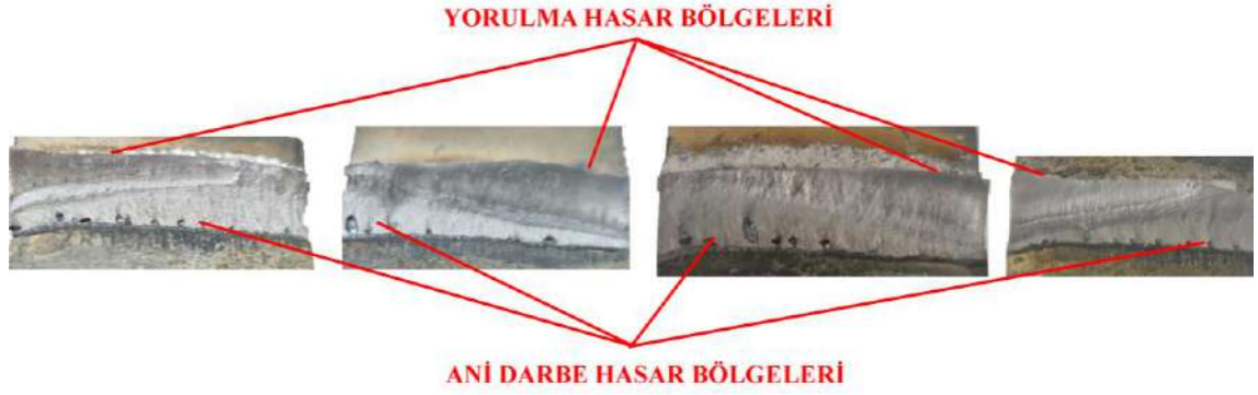
Şekil 4.41. Yorulma testleri sonrası hasar bölgeleri
