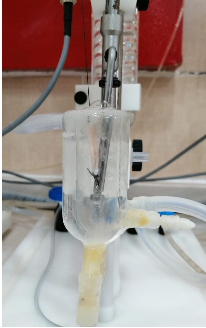
Şekil 3. 5 İzole organ banyosuna yerleştirilmiş uterus düz kas şeridi.
