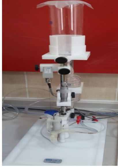
Şekil 3. 2 İzole organ banyosu sisteminin haznelerinden biri
