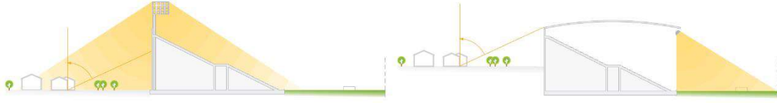
Şekil 4.4. Işık Kirliliğini Azaltmaya Yönelik Uygun (sağda) ve Uygun Olmayan (solda) Çözüm Örnekleri [89]
