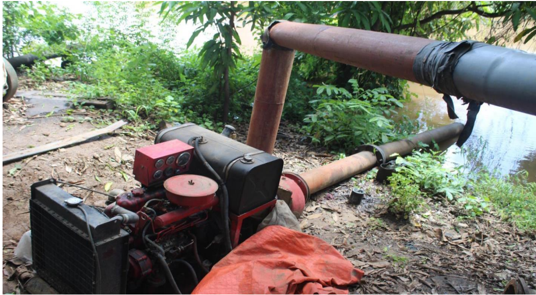
Şekil 3.5 Afgooye bölgesindeki Shabelle nehrini kullanan dizel su pompalama sistemi
