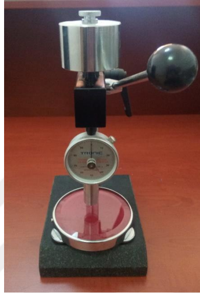
Şekil 4.11 Sertlik ölçümünde kullanılan LAC-YJ model durometre (Shore A)
