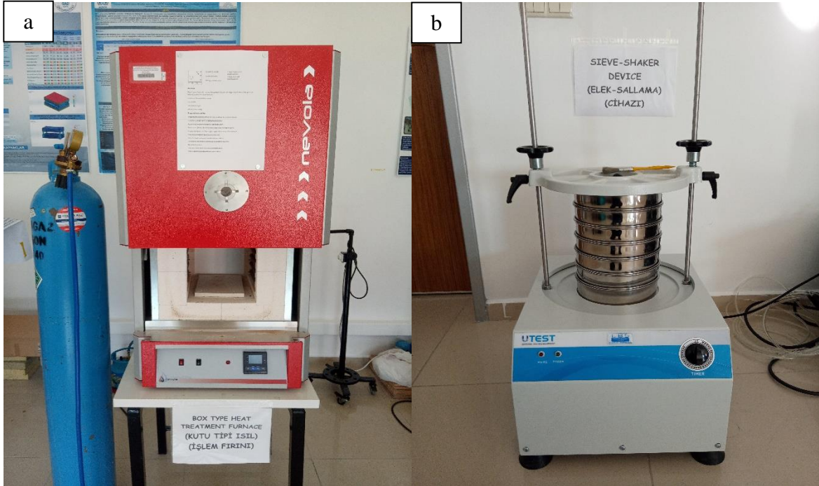
Şekil 4.1. a) Nevola marka ısıl fırın b) LBS utest model elek sallama cihazı
