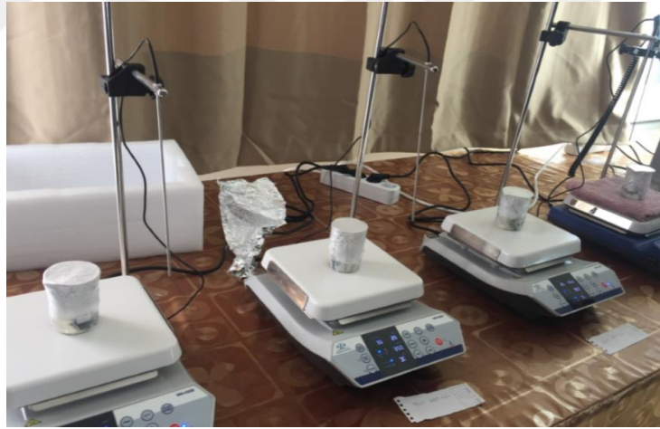
Şekil 4.5 Denede kullanılan WN-H550 model manyetik karıştırıcılar
