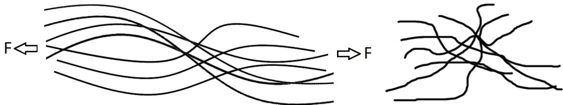
Şekil 3.2 Kuvvet etkisindeki zincirlerin düzenli bir yönelmesinin şematik görüntüsü
