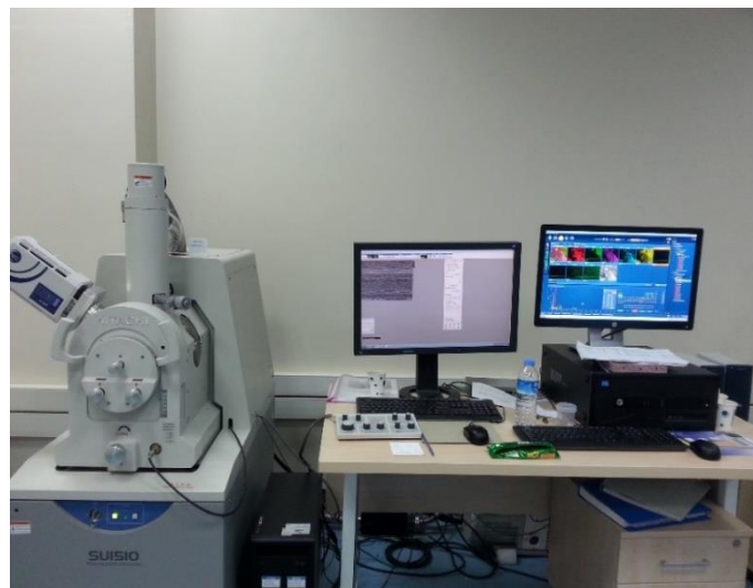
Şekil 4.16 Hitachi VP-SEM SU1510 model SEM ünite sistemi
