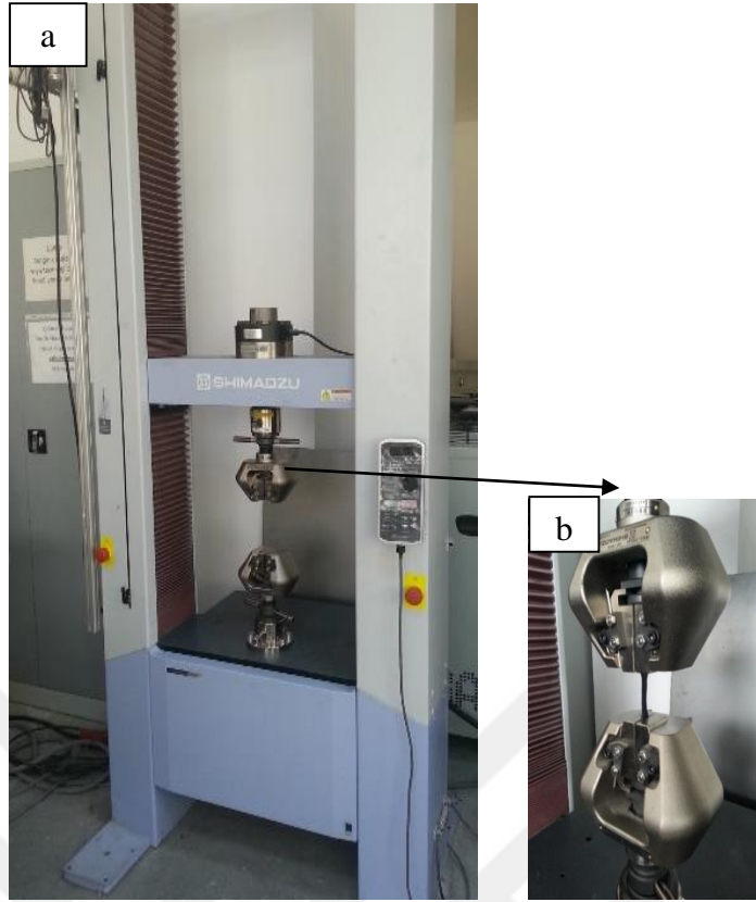
Şekil 4.12.a) Deneysel çalışmada kullanılan çekme cihazı b) Çekme çenesi
