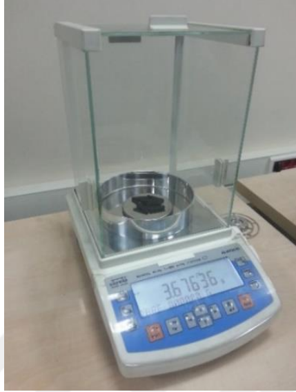
Şekil 4.10 Çalışmada kullanılan AS 60/220.R2 model hassas terazi
