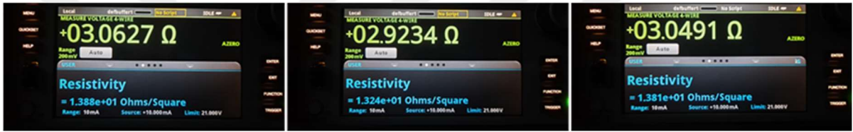
Şekil 4.13. ITO-6 örneğinin 450 ^{\circ}\text{C} 'de 30 dakika tavllanması sonucu farklı noktalarından alınan elektriksel direnç ölçümleri.
