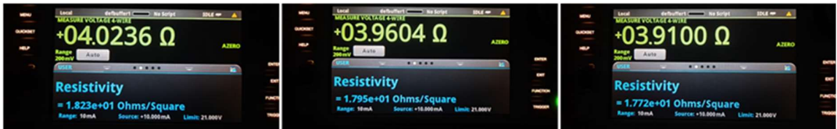
Şekil 4.14. ITO-7 örneğinin 450 ^{\circ}\text{C} 'de 5 dakika tavllanması sonucu farklı noktalarından alınan elektriksel direnç ölçümleri.
