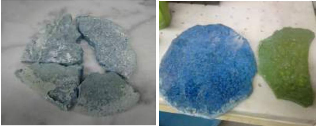
Fotoğraf: 89 Sır yapımında kullanılmak üzere hazırlanmış frit
