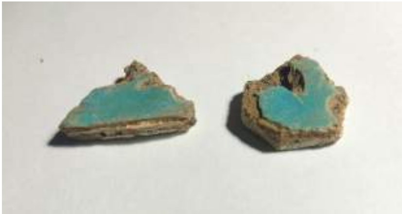
Fotoğraf: 355d Yapıya ait yaklaşık 5 mm kalınlığında çini parçalar
