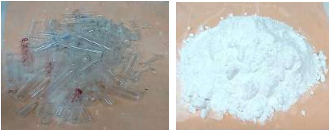
Fotoğraf: 86 Cam kırıkları ve öğütülmüş cam tozu
