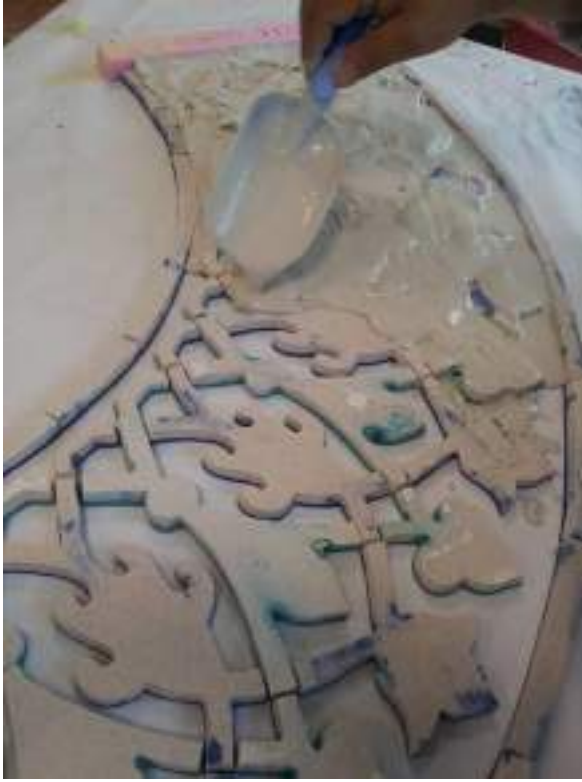
Fotoğraf: 123 Mozaik çini parçaların belli ölçülerde birleştirilmesi
