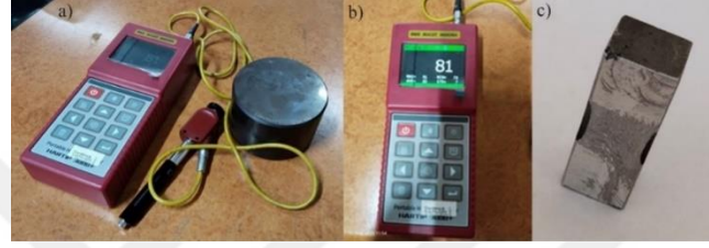
Şekil 3.9. Sertlik testi a,b)Sertlik test cihazı, c)Sertlik test numunesi
