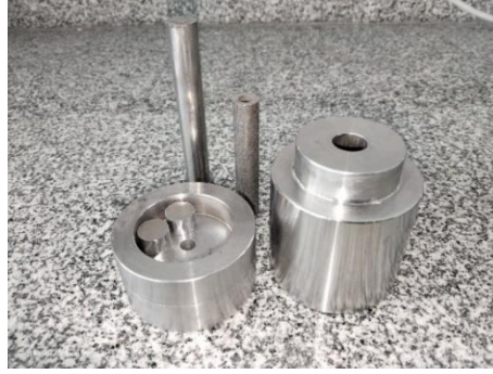
Şekil 3.7. Basma numunelerinin üretiminde kullanılan sıkıştırma kalıbı
