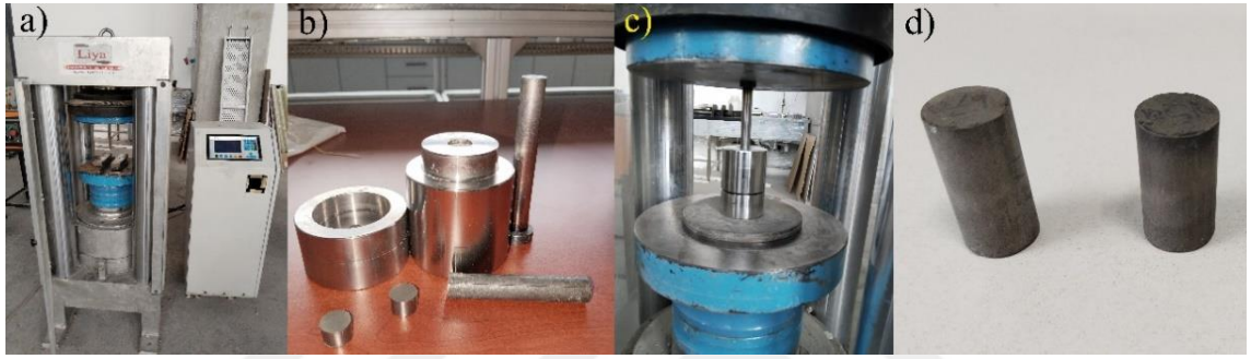
Şekil 3.4. Tozların sıkıştırılması a) Hidrolik pres, b) Sıkıştırma kalıbı, c) Presleme işlemi d) Hibrit kompozitler
