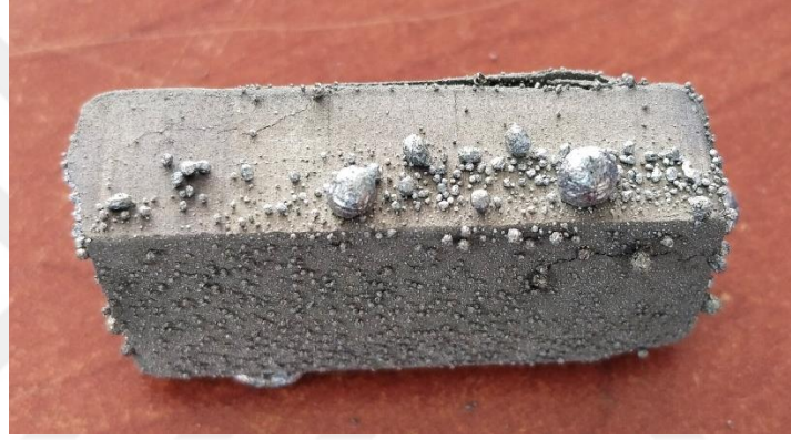
Şekil 4.23. Ön testlerde 300 MPa sıkıştırma basıncı ve 590°C sinterleme sıcaklığında numunede görülen sinterleme hatası (ön testlerde eğme test kalıbı kullanılmıştır, geometri dikdörtgen formundadır)
