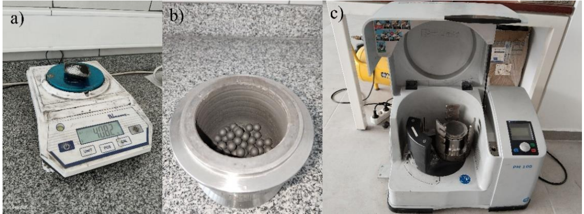
Şekil 3.2. Bilyeli öğütme işlemi a) Hassas tartım, b) Bilye ve tozların karıştırma kovanına alınması, c) Mekanik alaşımlama cihazı
