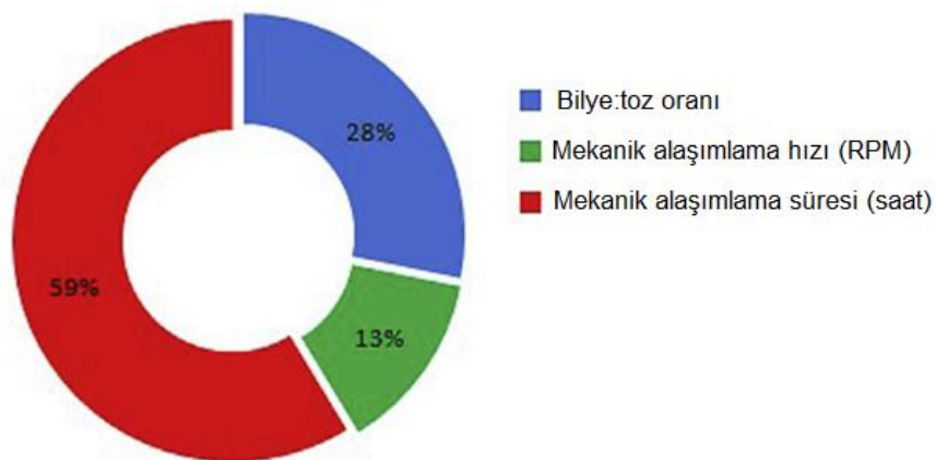
Şekil 2.1. Mekanik alaşımlama parametrelerinin mekanik özelliklere etkisi (Dwivedi ve ark., 2021)
