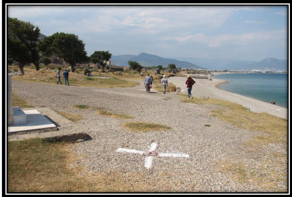
Şekil 8.12. Yer Kontrol Noktasına kireçle + işareti ve ortasına spreyle nokta işareti koyulması
