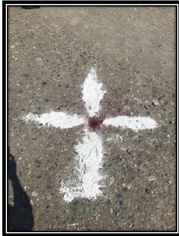
Şekil 8.2. Yer Kontrol Noktaları belirlemede kullanılan kireç ve sprej kullanım örneği
