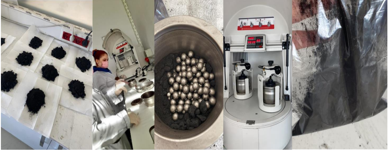
Şekil 3.6 Mısır biyokömüründen bilyalı öğütme yaklaşımı ile nano-biyokömür eldesi
