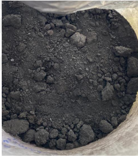
Şekil 3.5 Mısır artıklarından 450°C'de piroliz sonrası biyokömür eldesi
