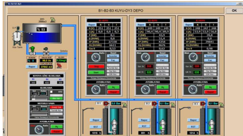
Şekil 4.2. SCADA kuyu-depo sistem görüntüsü
