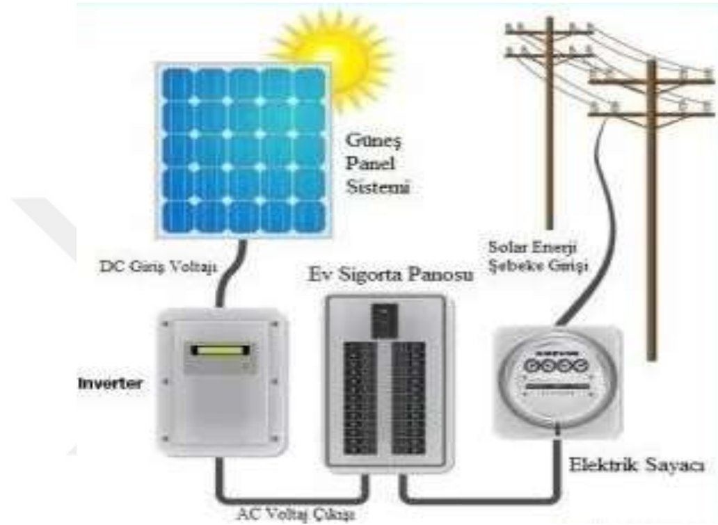
Şekil 4.5. Şebekeye bağlı fotovoltaik sistem (Özçelik vd., 2020).
