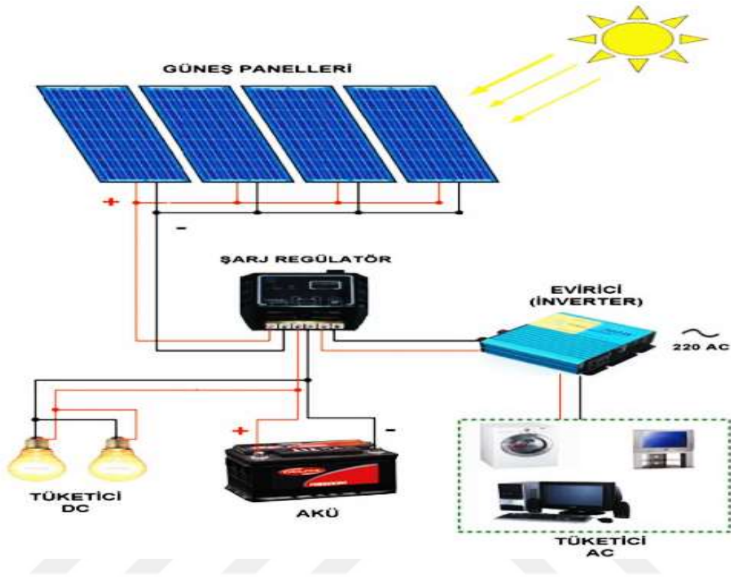
Şekil 4.6. Şebekeden bağımsız fotovoltaik sistem (Akkaş ve Çam, 2020).
