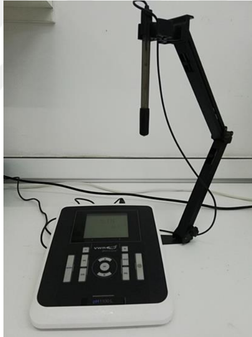
Şekil 3.3. Thermo Orion Model 9206BNWP pH elektrodu ve onun bağlı bulunduğu VWR marka pH-iyon metre.
