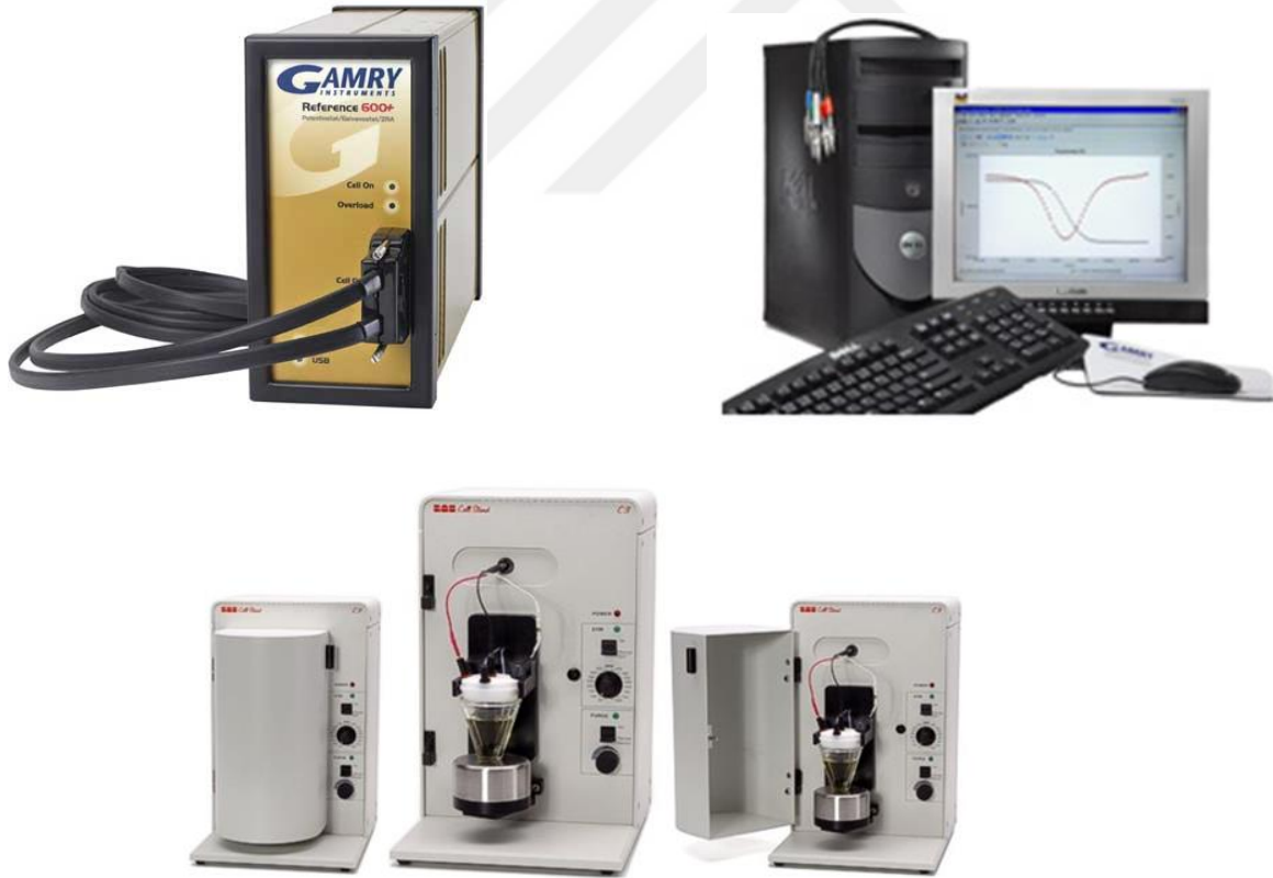
Şekil 3.1. Voltametri ve impedans deneylerinin gerçekleştirildiği GAMRY reference 600+ ve Series 750 elektrokimyasal analizörleri ve C3 hücre sistemi.
