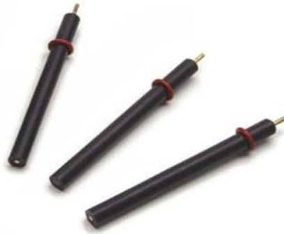
Şekil 1.21. Katı çalışma elektrotu örneği.
