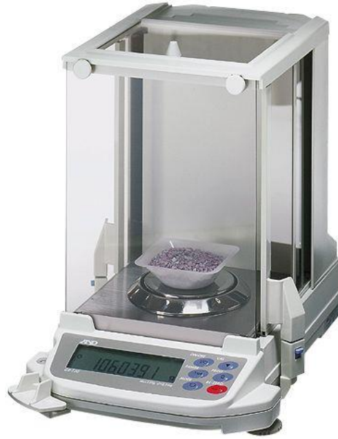
Şekil 3.2. A&D COMPANY N92 model, 0.1 mg duyarlılıkla tartım yapan elektronik terazi.
