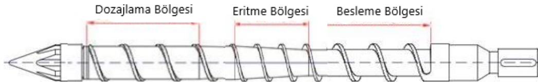
Şekil 3. 9. Vidalı Karıştırıcı Vida Kısmı [76]
