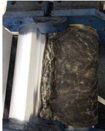
Şekil 4. 2. Çalışmada Kullanılan Çift Silindirli Karıştırıcı
