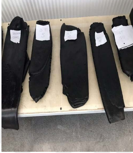
Şekil 4. 3. Silindir Karıştırıcıdan Elde Edilen Numuneler
