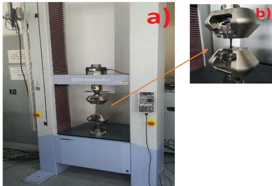
Şekil 4. 15. a) Tensometre (Çekme) Cihazı ve b) Çekme Çenesi
