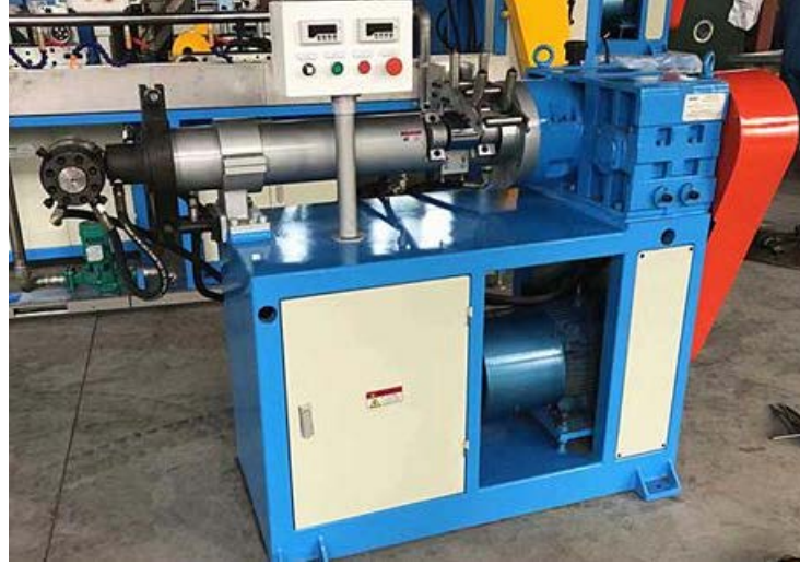
Şekil 3. 8. Vidalı Ekstrüzyon Makinası [75]
