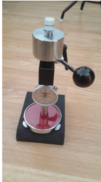
Şekil 4. 14. Sertlik Ölçme Cihazı (Durometre-Shore A)
