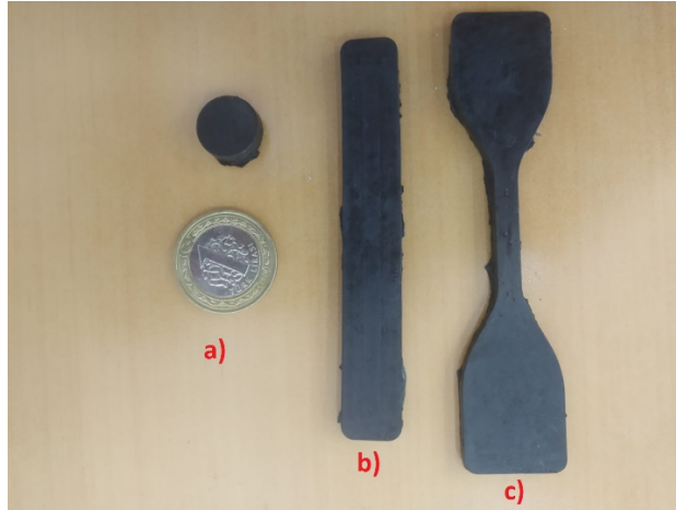
Şekil 4. 5. Vulkanizasyon Sonrası Elde Edilen Test Numuneleri a)Yoğunluk ve Sertlik, b)Yırtılma c)Çekme
