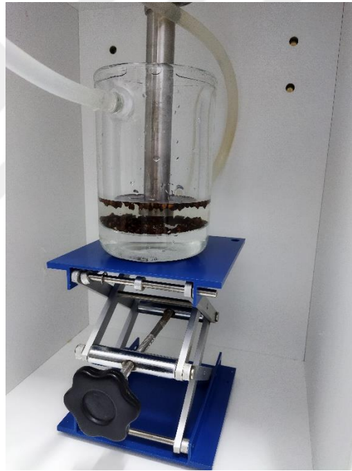
Şekil 3.1. Sıcaklık kontrolü sağlanan beher içerisinde tohumlara ultrason uygulama işlemi
